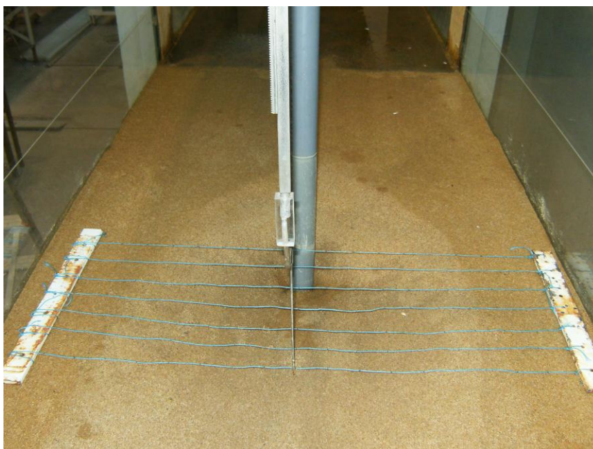
Fig. A.7 – Método de medição com recurso ao limnómetro e a uma malha de pontos
