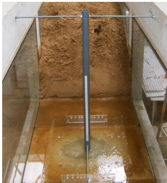
Fig. 3.6 – Instalação do pilar
