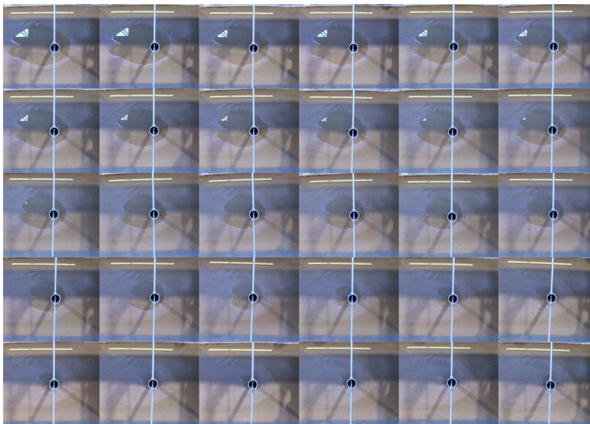
Fig. A.6 - Drenagem da água na cavidade de erosão ao longo do tempo
