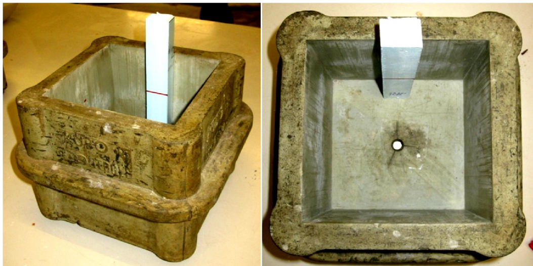
Fig.5.22. – Molde utilizado para fabrico dos provetes.
