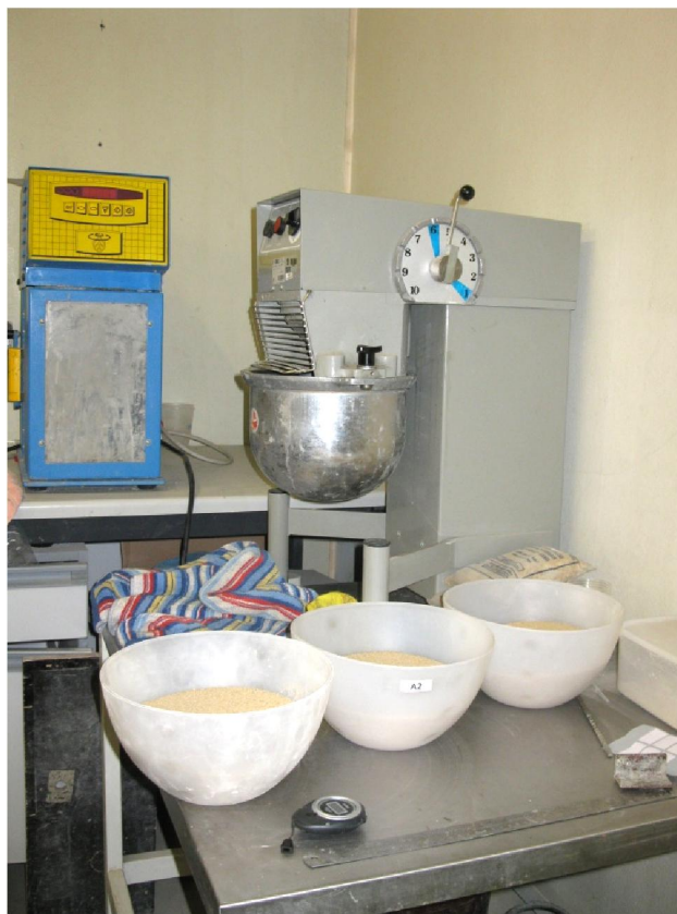
Fig.4.15. – Misturadora utilizada para efetuar as três amassaduras.
