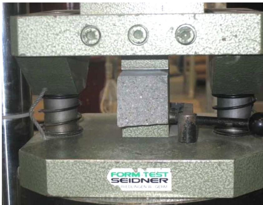
Fig.3.12 – Exemplo de ensaio de Compressão no meio prisma. [63]
