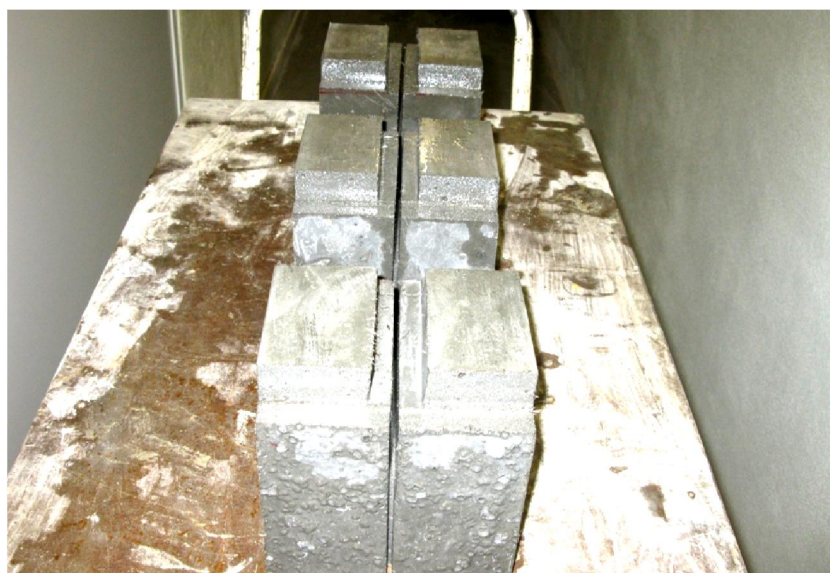
Fig.5.29. – Provette com espaço para fixação dos LVDT's.
