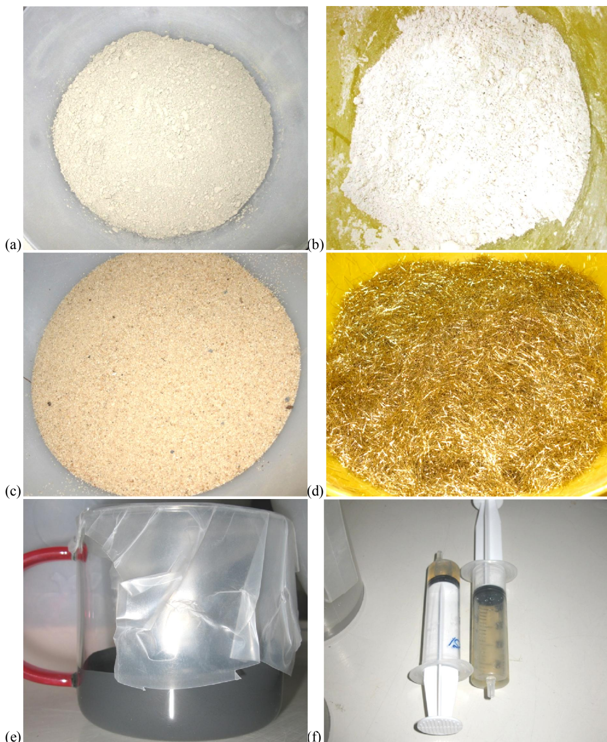
Fig.3.8 – (a) Cimento (CEM I 42,5 R), (b) Fíler calcário (BETOCARB P1 – OU), (c) Areia, (d) Fibras de 9mm (KrampeHarex DM), (e) Sílica de fumo em suspensão (Centrilit Fume SX), (f) Superplastificante (Sika Viscocrete 20HE).
