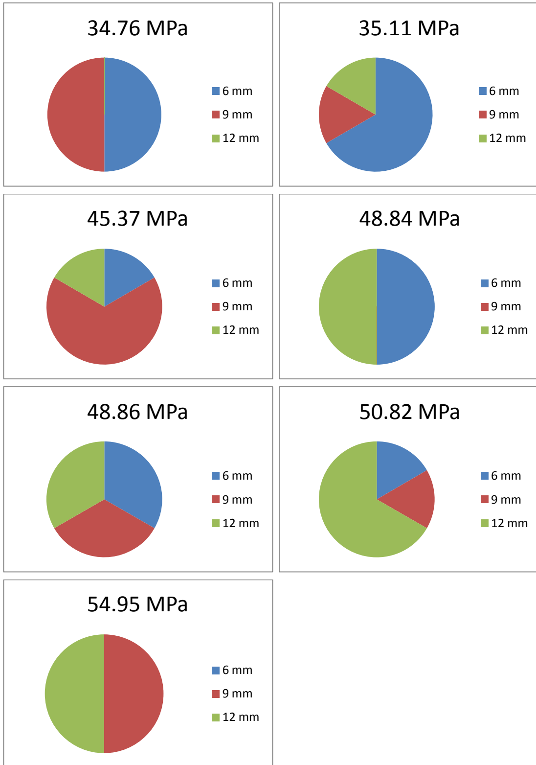
Fig.3.16 – Resistência à tração por flexão obtida em prismas 4x4x16 cm e contribuição de cada tipo de fibras.
