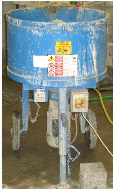
Fig.4.27. – Misturadora utilizada no fabrico dos provetes com fibras de 9+12mm.
