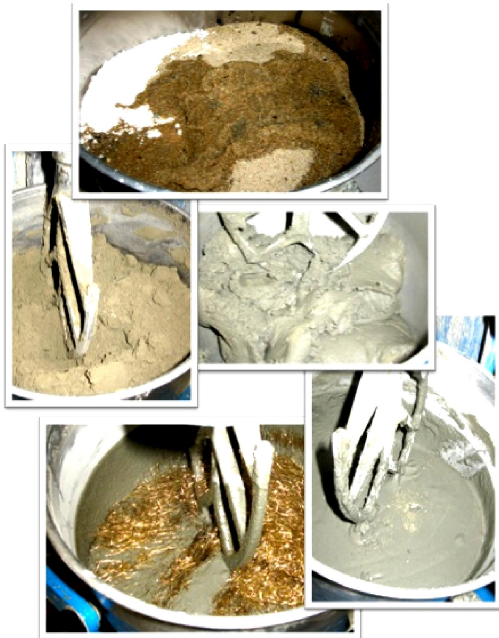
Fig.3.9 – Diferentes fases do processo de amassadura.
