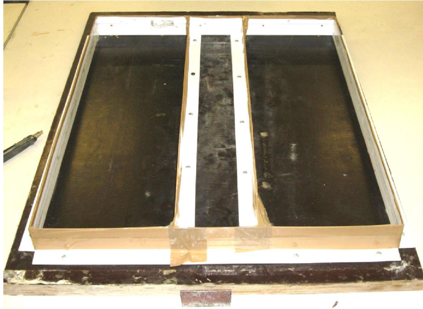
Fig.4.23. – Molde utilizado para o fabrico 2 placas.
