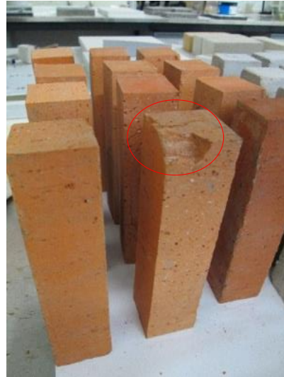
Figura 3.2 – Provetes de tijolo com irregularidades, provenientes da desagregação de um vértice
