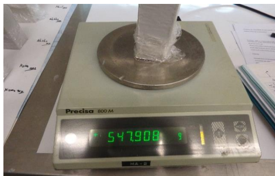
Figura 3.59 – Pesagem dos provetes isolados na balança
