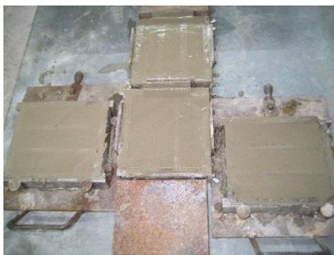
Figura 3.15 – Secagem da argamassa
