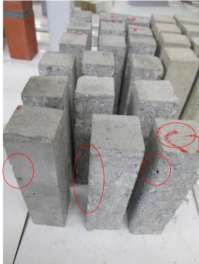
Figura 3.1 – Provetes de betão com presença de tinta na face superior
