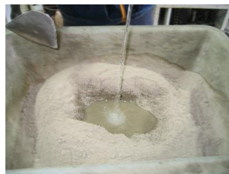
Figura 3.12 – Adição de água
