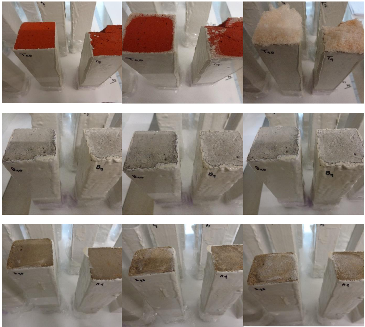
Figura 3.69 – Evolução das manifestações do nitrato de sódio dissolvido em menores quantidades nos materiais
