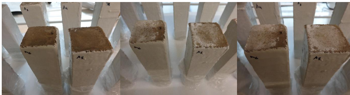
Figura 3.65 – Evolução das manifestações do cloreto de sódio dissolvido em menores quantidades nos materiais
