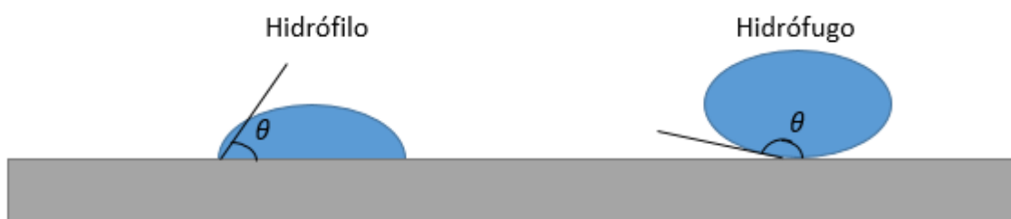
Figura 2.11 – Representação de uma superfície hidrófila, e de uma superfície hidrófuga
