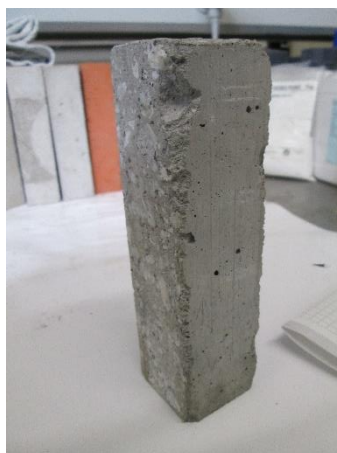
Figura 3.7 – Provete de betão com bolhas de ar e faces rugosas
