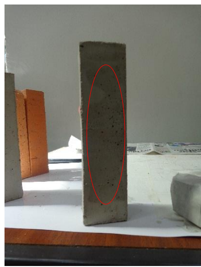
Figura 3.4 – Presença de manchas de humidade nalguns provetes de argamassa
