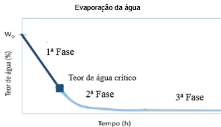
Figura 2.14 – Curva de secagem de materiais porosos
