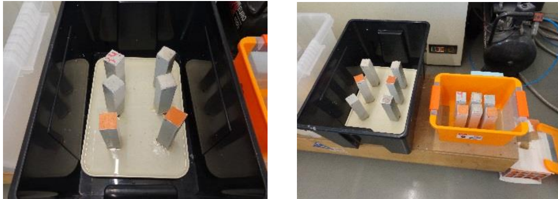
Figura 3.29 – Provetes no decorrer dos ensaios de absorção capilar
