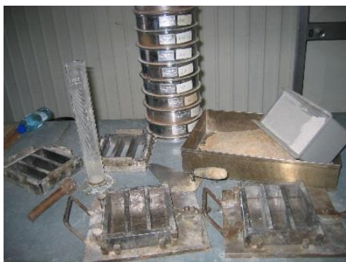
Figura 3.9 – Material auxiliar necessário à sua concepção: moldes, peneiros
