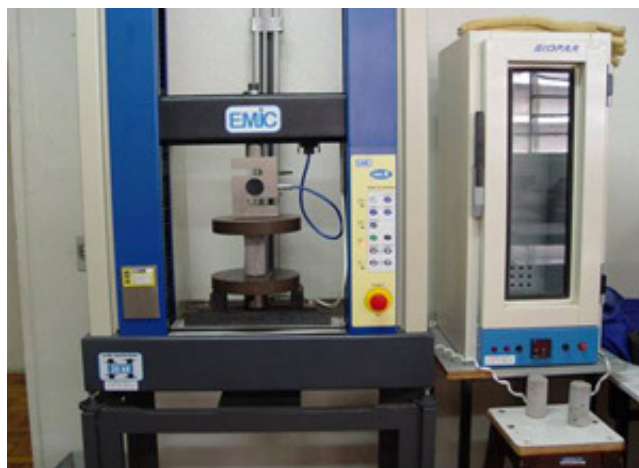
Figura 15 - Equipamento para a realização do ensaio à compressão uniaxial ( http://www.pdig.pt )
