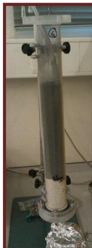
Figura 18 - Coluna 6 (resíduos mineiros sobre cascas de marisco como camada drenante).
