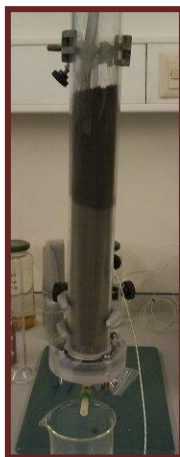
Figura 15 - Coluna 3 (cobertura de composto sobre resíduo mineiro).
