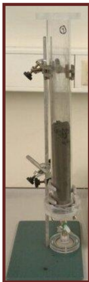
Figura 13 - Coluna 1 (padrão apenas com resíduos mineiros).
