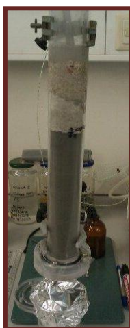
Figura 17 - Coluna 5 (cobertura de cascas de marisco sobre os resíduos mineiros).
