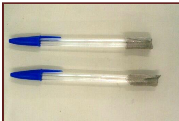
Figura 11 - “Tubagem” utilizada para captação de ar no interior dos resíduos.
