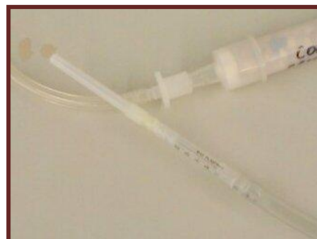
Figura 10 - Seringa utilizada na recolha de ar.
