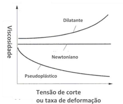
Figura 18- Curva de viscosidade de um fluido em função da tensão de corte ou da taxa de deformação (adaptado [5])
