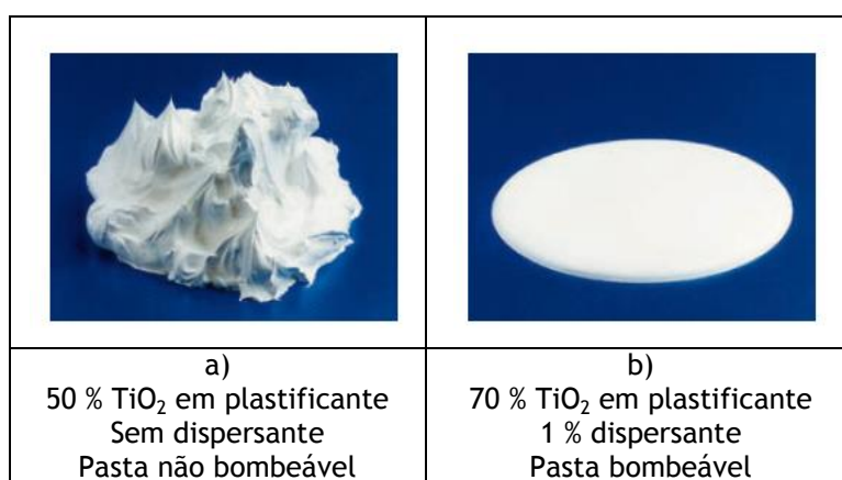
Figura 15- Pasta de pigmento a) sem dispersante b) com 1 % dispersante (adaptado [9])
