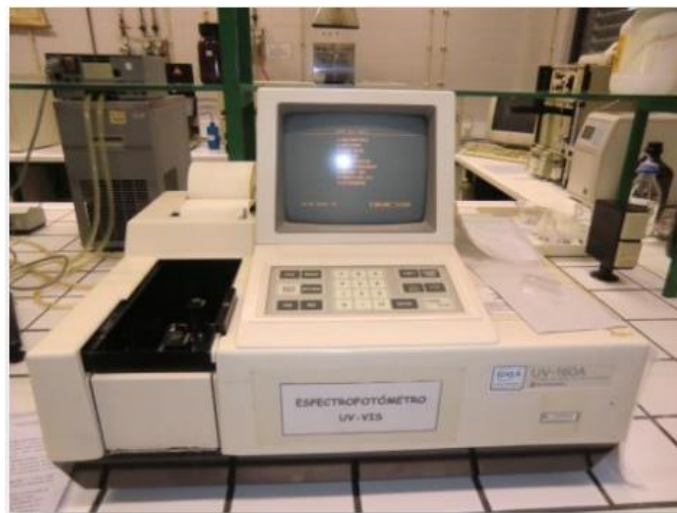
Figura 3.3- Espectrofotômetro UV/Vis utilizado na avaliação do crescimento das culturas pelo método de densidade ótica.
