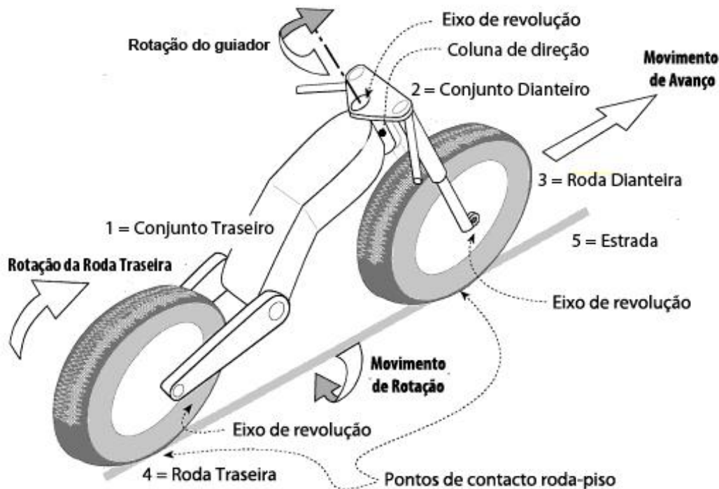
Figura 2.7 - Estrutura Cinemática de um Motociclo. Adaptado de (2)
