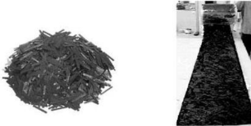
Figura 2.18 - Pré-impregnado sob a forma de volume (esquerda) e sob a forma de folha (direita)
