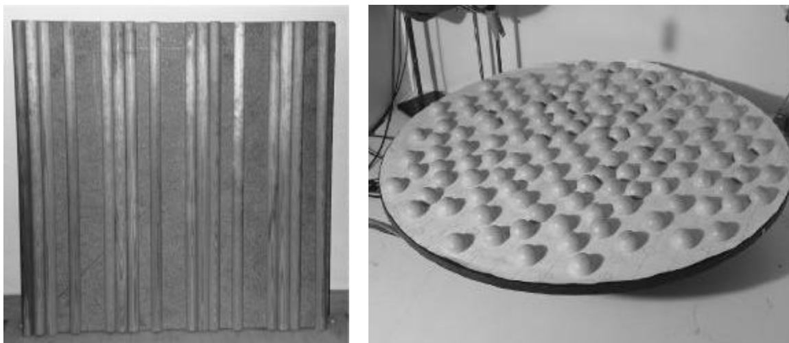
Fig. 5.26 – Amostras utilizadas para determinação do coeficiente de espalhamento. À esquerda amostra com ripas cilíndricas e à direita amostra com semiesferas dispostas aleatoriamente sobre uma placa de suporte. [30]
