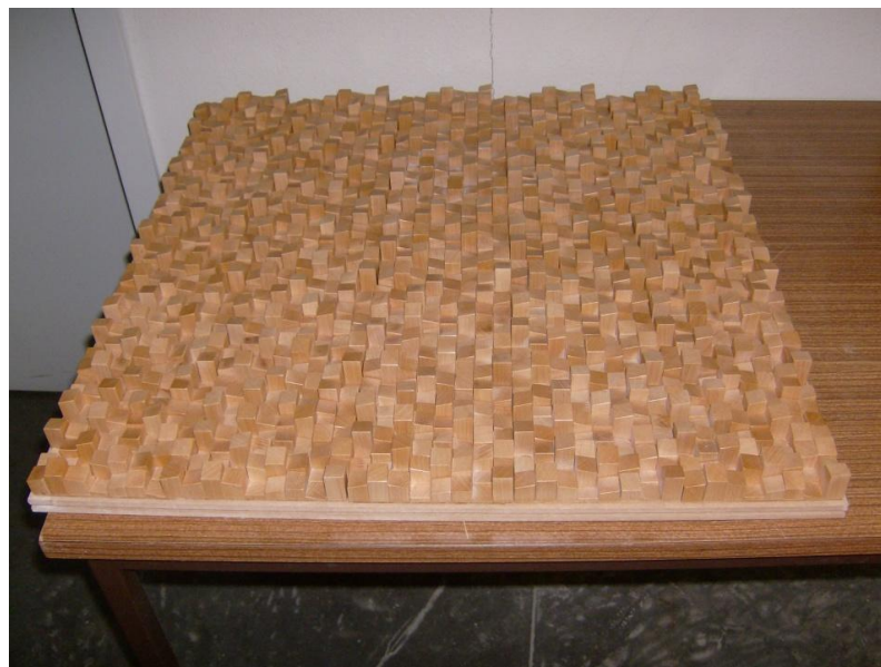
Fig. 5.16 – Amostra à escala 1:5 composta por 25 painéis Multifuser Wood 64.
