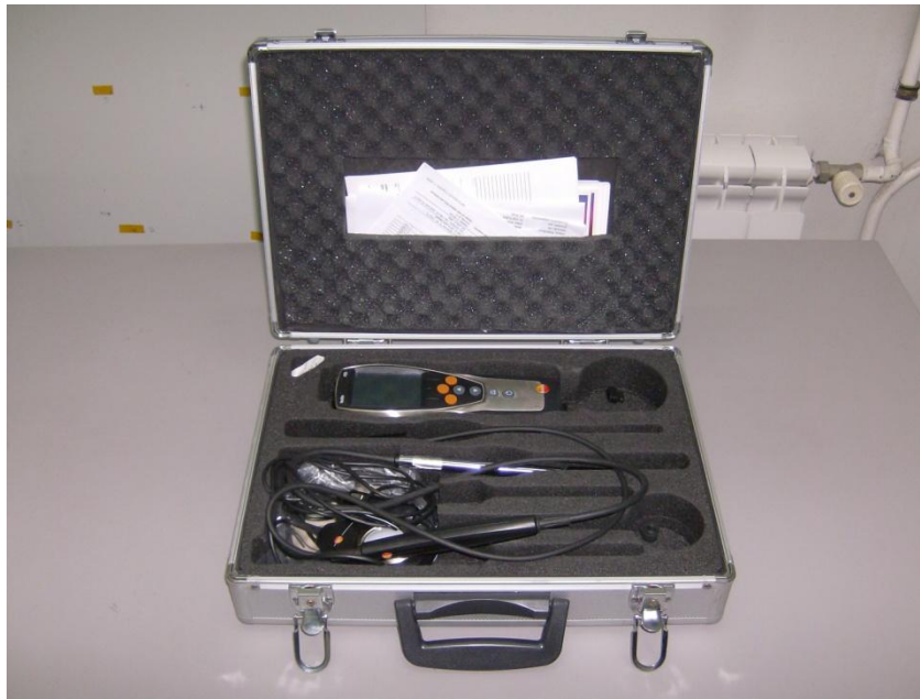
Fig. 5.19 – Equipamento de medição da temperatura e humidade relativa.
