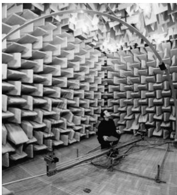
Fig. 2.11 - Goniómetro 3D mais sistema hemisférico para Difusores 2D. [1]
