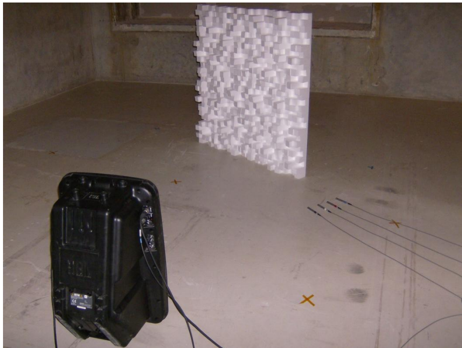
Fig. 5.7 – Ensaio para determinação do coeficiente de difusão: colocação dos microfones nos ângulos 0^\circ , 5^\circ , 10^\circ e 15^\circ .
