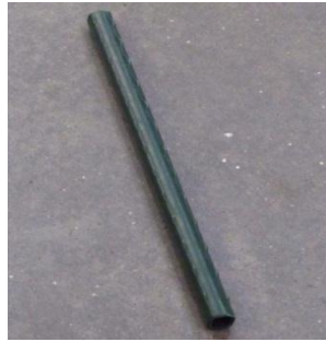
Figura 3.31 - Haste metálica utilizada para simular vegetação rígida.
