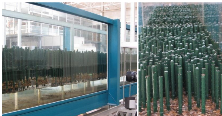
Figura 3.30 - Canal de ensaios com a presença de hastes.
