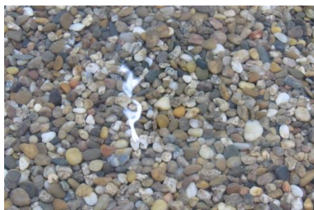
Figura 3.14 - Material usado para a construção do leito rugoso.
