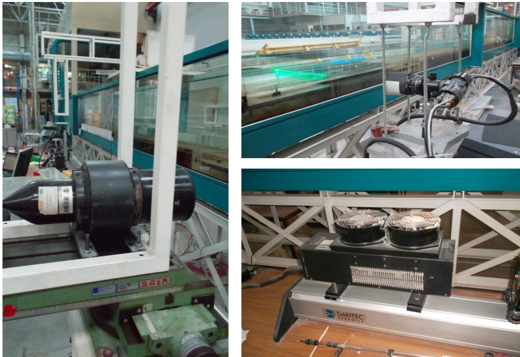
Figura 3.4 - Sonda do laser (à esquerda), foto-detetor (em cima à direita) e cabeça do laser (em baixo à direita).
