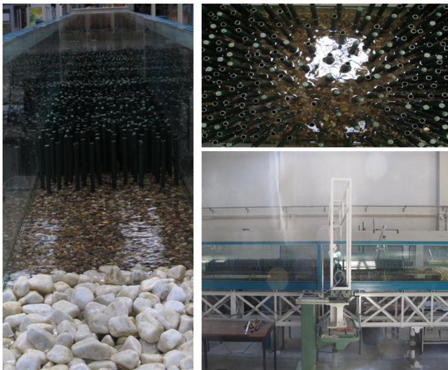
Figura 3.33 - Soleira de jusante e canal com vegetação rígida – vista de jusante (esquerda); Vegetação rígida – vista de cima (direita, canto superior); Vista frontal do canal do laboratório (direita, canto inferior).
