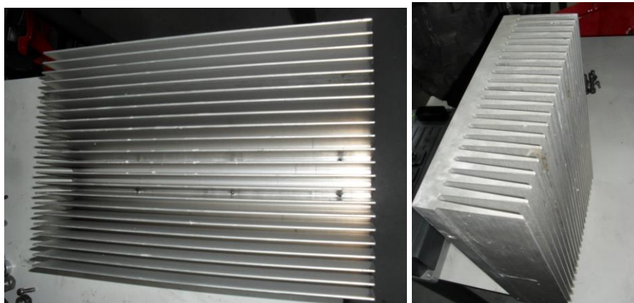
Figura 52 - Dissipador de calor do controlador
