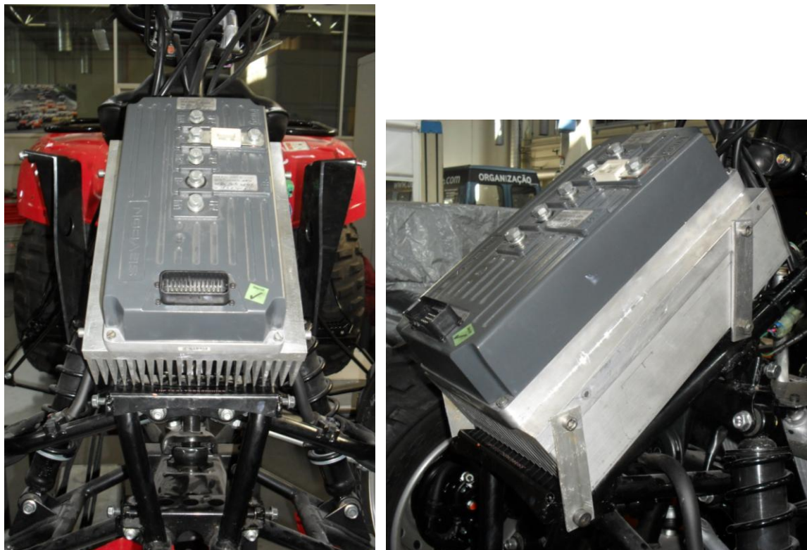
Figura 64 - Controlador e dissipador acoplado na moto
