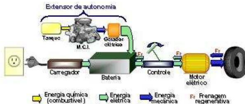
Figura 9 - Esquema de funcionamento de um veículo eléctrico com extensão de autonomia
