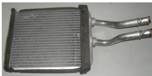
Figura 42 - Permutador de calor (radiador)
