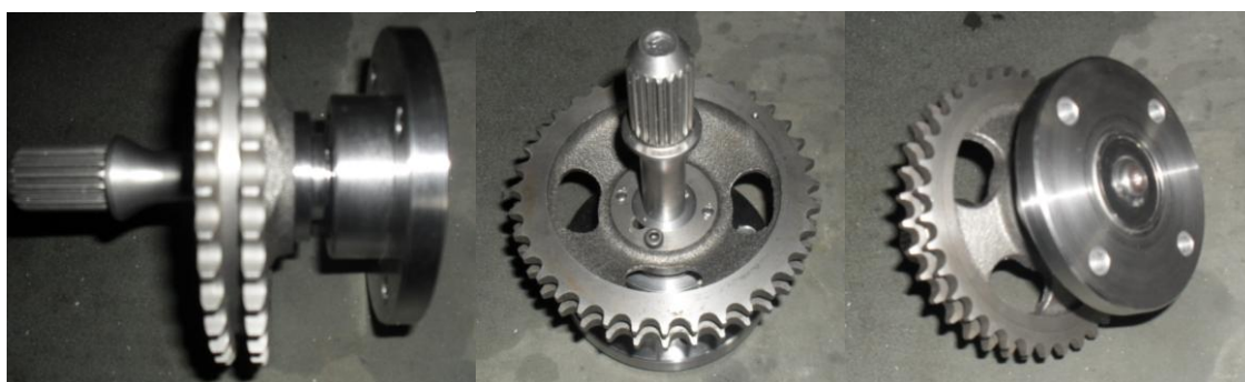
Figura 57 - Montagem do veio alterado
