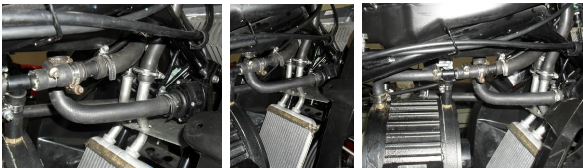
Figura 63 - Ligação do circuito de refrigeração
