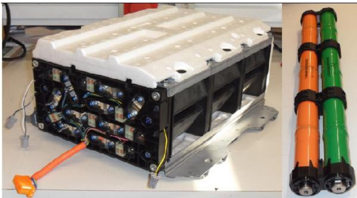
Figura 45 - Pack de baterias Ni-MH, com invólucro, ligações e terminais para sensorização, à esquerda. Na direita um módulo composto por 12 células.
