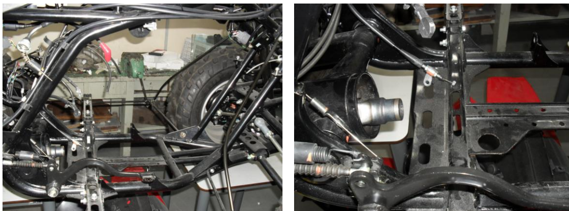
Figura 54 - Moto depois de retirar o motor de combustão
