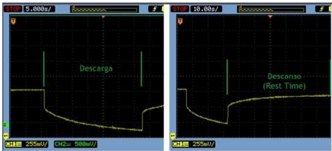
Figura 47 - Resposta da tensão da bateria a uma carga: dinâmicas de descarga e rest time.
