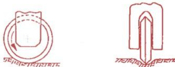
Figura 5.11 – Discos cortadores (Díez, 2011).
