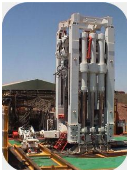
Figura 5.4 – Máquina de Raise Boring (Net)
