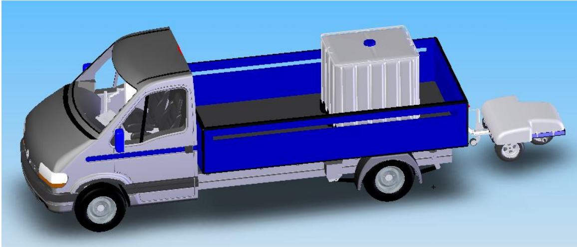
Figura 74 – Configuração do FFT – veículo tractor/IBC/atrelado FFT
