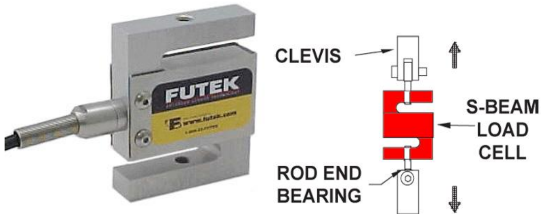
Figura 59 – Célula de carga que irá ser utilizada para instrumentar a correia [FUTEK, 2012. Disponível em: http://www.futek.com/product.aspx?stock=FSH00958 ]
