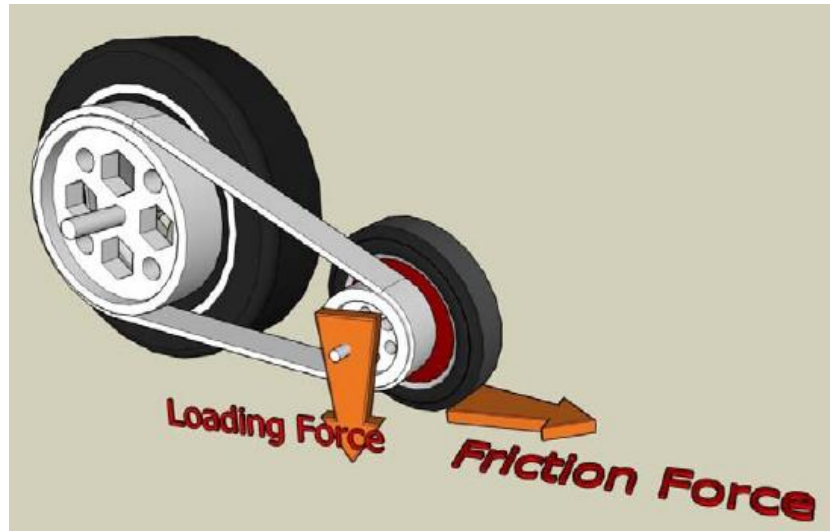
Figura 54 – Sistema mecânico do equipamento de medição de atrito com rodas parcialmente bloqueadas [Adaptado de EASA, 2010]
