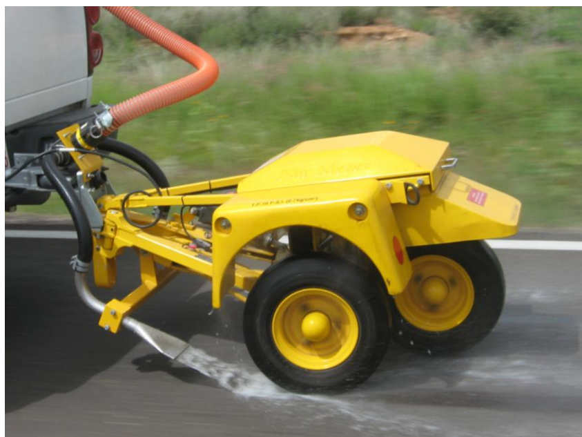
Figura 32 – Medição de atrito com Mμ-Meter – detalhe do sistema de aspersão de água
