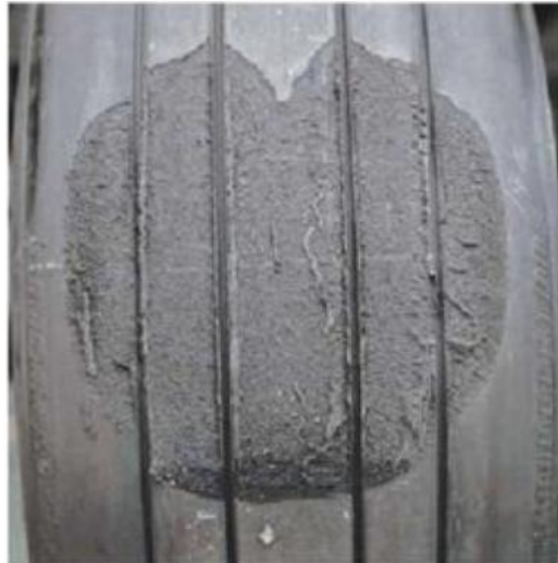
Figura 17 – Zona de contacto de um pneu de um avião que sofreu aquaplaning por desvulcanização. [FILHO, 2006 cit in SOARES, A., 2011]
