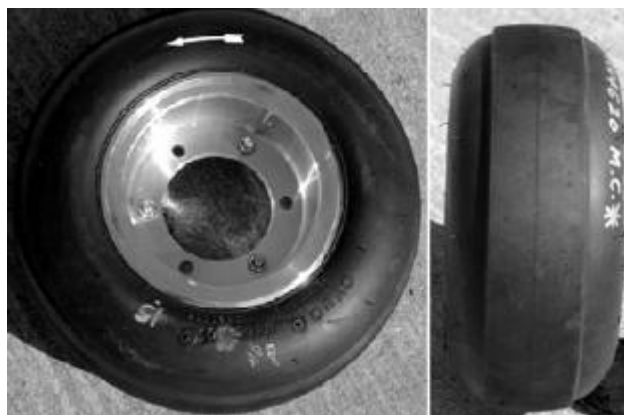
Figura 63 – Pneu de teste ASTM E1551-93 E a utilizar no protótipo [Adaptado de EASA, 2010]
