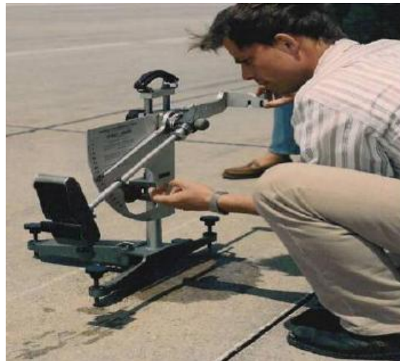
Figura 22 – Exemplo da medição de atrito através do pêndulo britânico.
