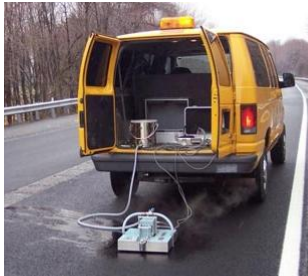
Figura 25 – Ensaio de medição de atrito com DFT [Nippo Sangyo CO., 2004]
