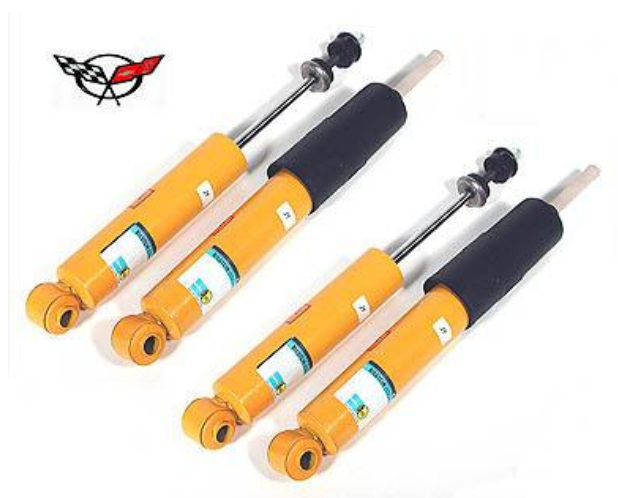
Figura 35 - Exemplo de um conjunto de amortecedores de elevada performance para um Corvette. [13]
