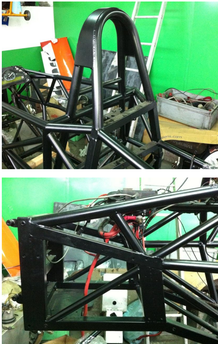
Figura 43 - Detalhe proteção de capotamento traseira e reforço frontal.
