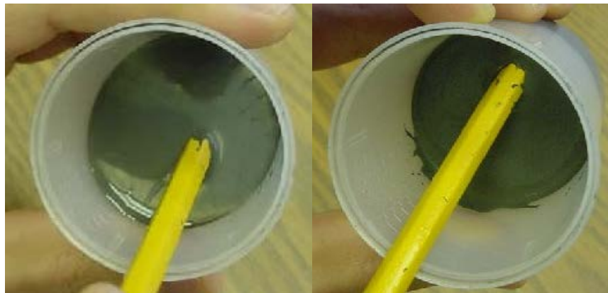
Fig. 78 - fluido MR líquido e sólido.
