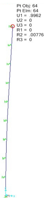
Fig. 9- Deformada da estrutura ao vento
