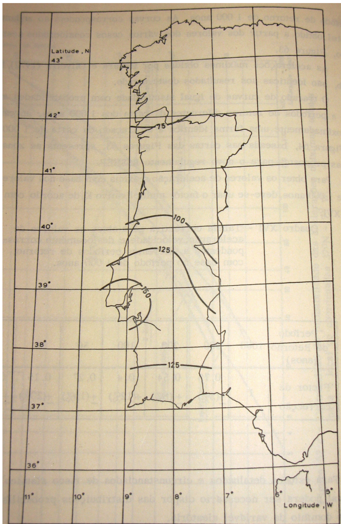
Fig. 82 - Acelerações máximas para um período de retorno de 1000 anos, com base no estudo experimental usando extrapolação parabólica ( \text{cm/s}^2 )
