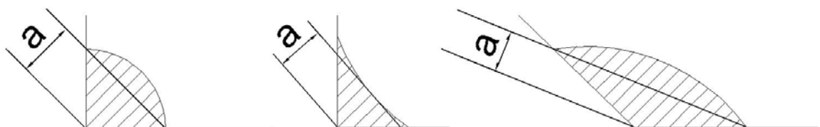
Fig. 55 - Espessura dos cordões de ângulo
