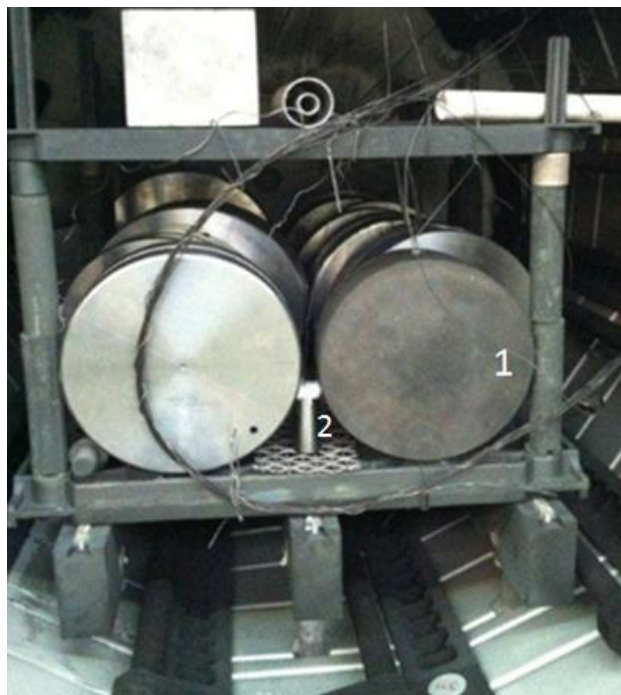
Figura 2.3 - Carga de peças a tratar com as peças de teste integradas (1 – disco de teste e 2 – cilindro de teste)
