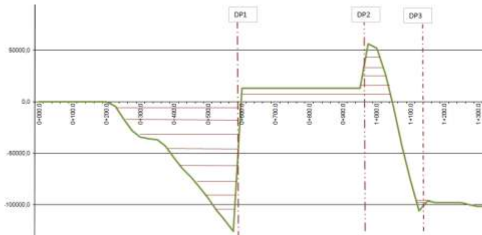
Fig.6.6 – Curva de Brückner Zona 1.1, tempo t3 – aterro do corpo e parte superior dos aterros com solos provenientes dos depósitos provisórios.
