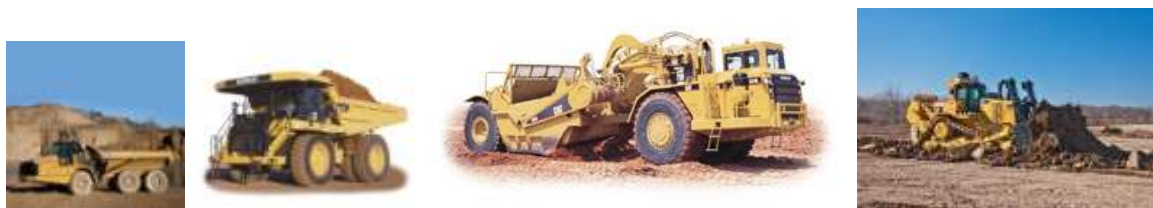
Fig. 3.2- Vários tipos de meios de transporte ao longo da linha, respetivamente: Camião articulado, Dumper , Scraper , Trator com lâmina.
