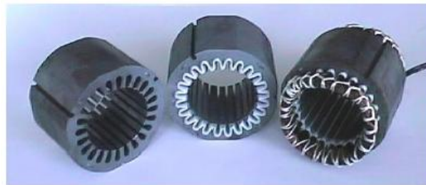
Figura 2.3 - Exemplo de estatores em diferentes etapas do processo de fabricação.
