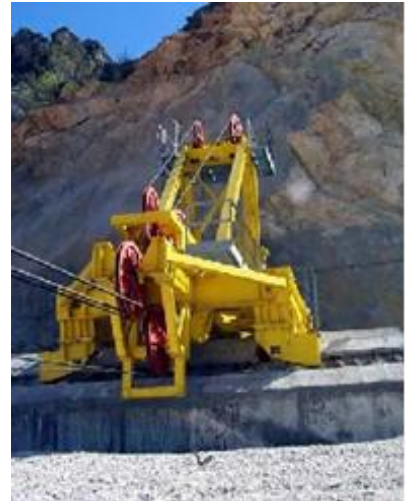
Fig. 2.5 - Carro de retorno de blondin paralelo
