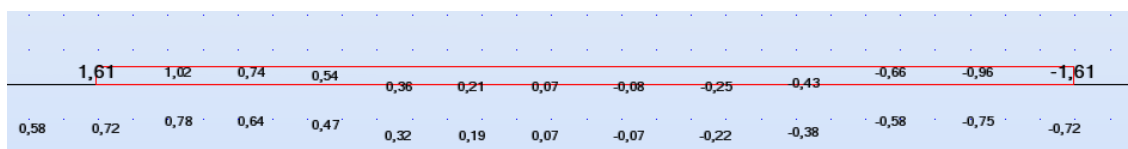
Fig. 4.12- Valores da extensão por retração com E=30GPa
