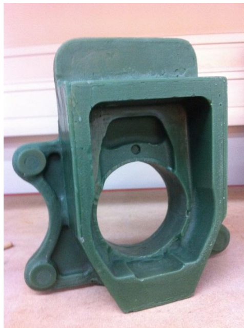
Figura 56 - Modelo da manga de eixo em cera
