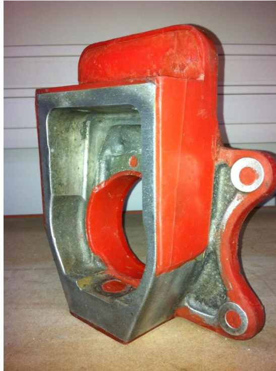
Figura 52 - Manga de eixo traseira preparada para à moldação
