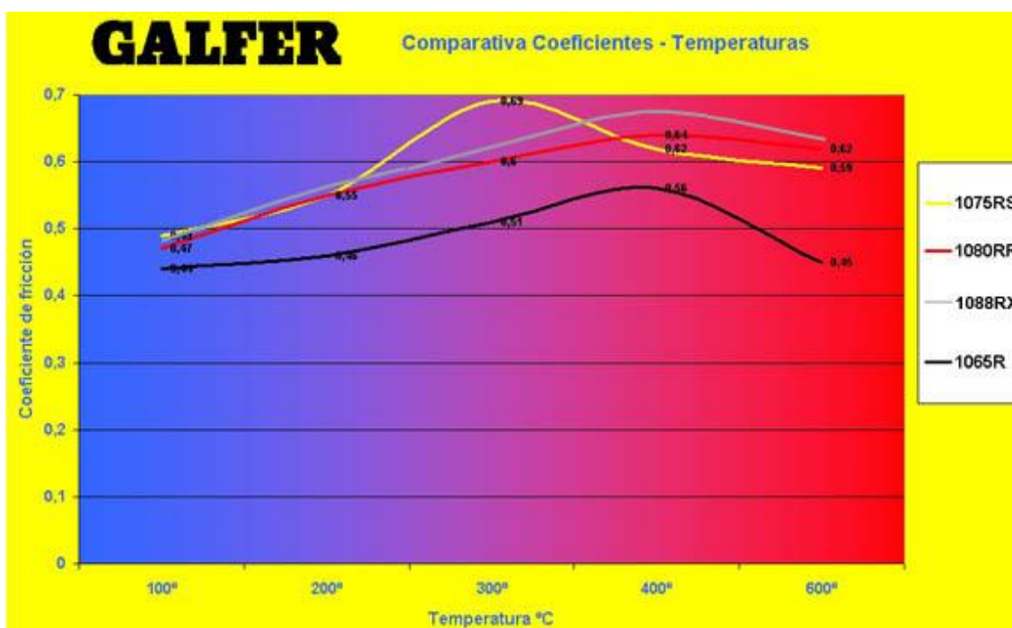
Figura 44 - Curva de coeficiente de fricção vs. temperatura para várias pastilhas da marca Galfer [24]
