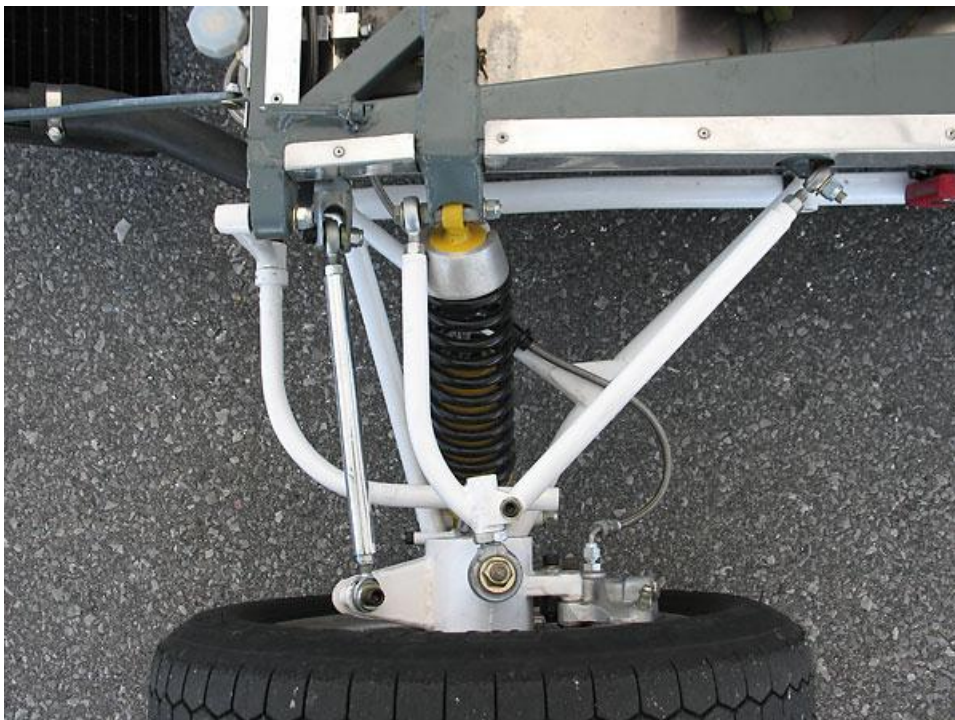
Figura 49 - Pormenor de um tubo de travão PTFE envolta de malha de aço num Formula [15]
