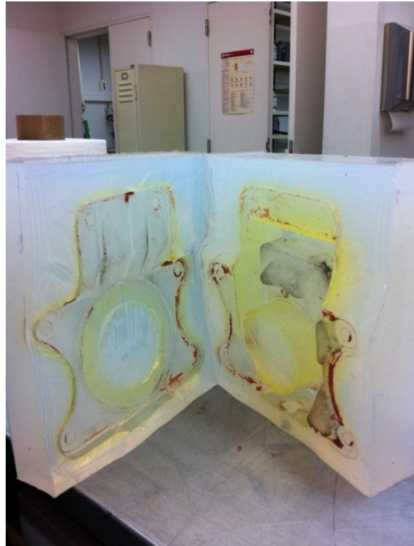
Figura 55 - Molde em silicone aberto
