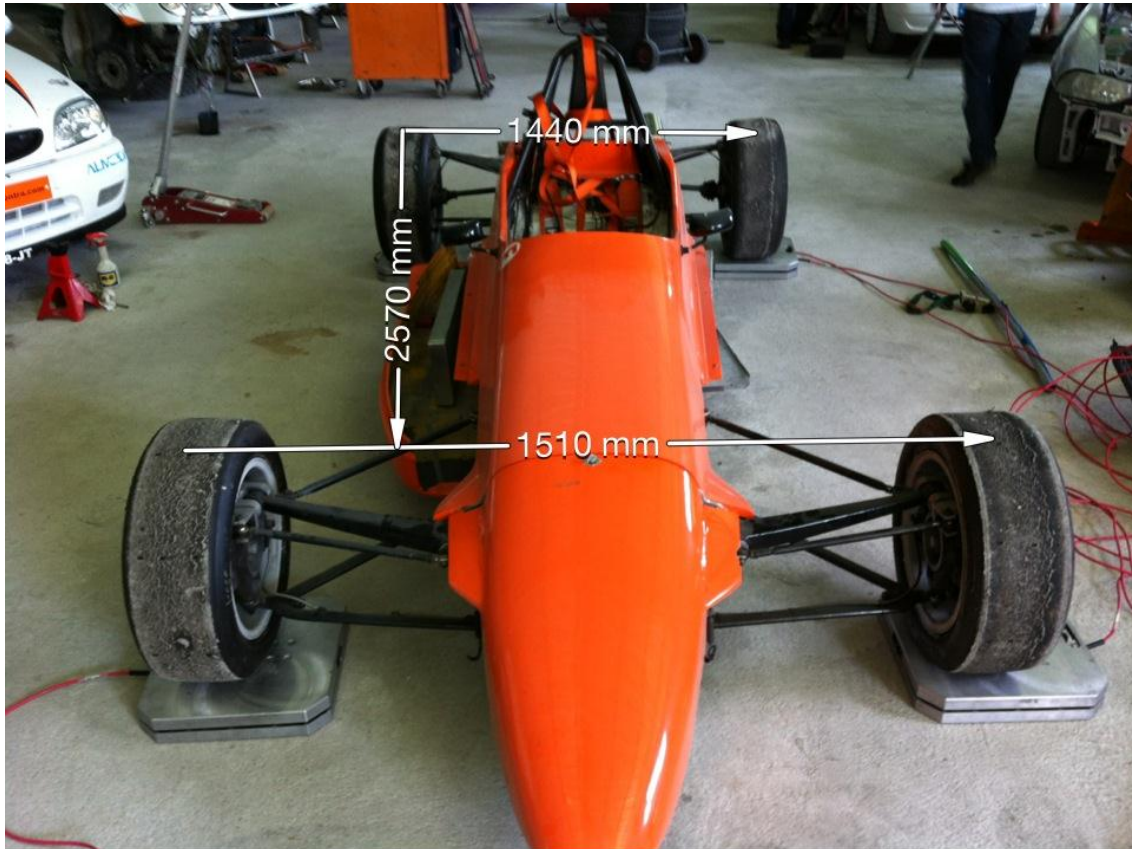
Figura 38 - Largura de vias da frente, traseira e distância entre eixos do Formula Vauxhall
