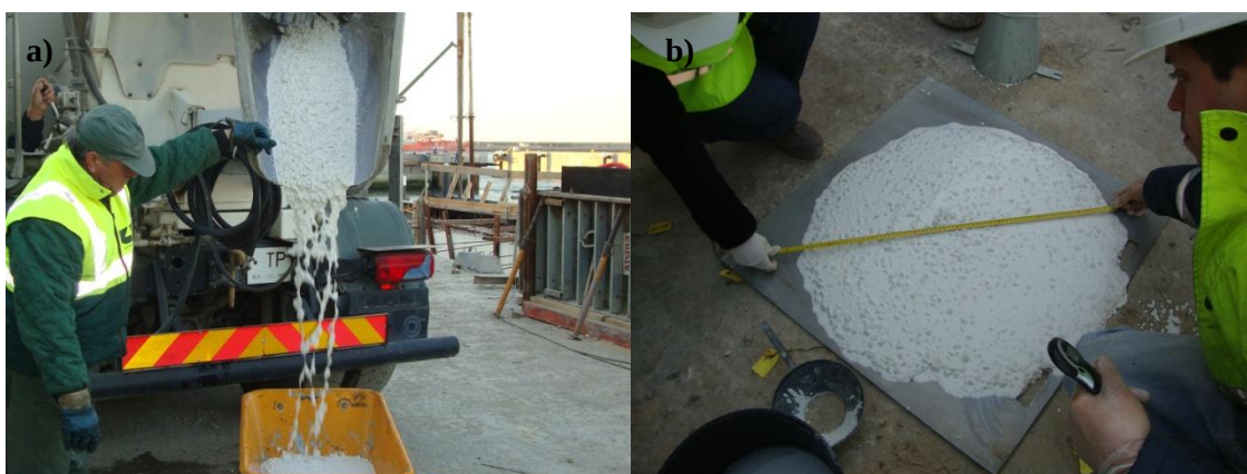
Fig. 3.7. – Primeira amassadura: (a) escoamento do BAC; (b) Ensaio de espalhamento do BAC
