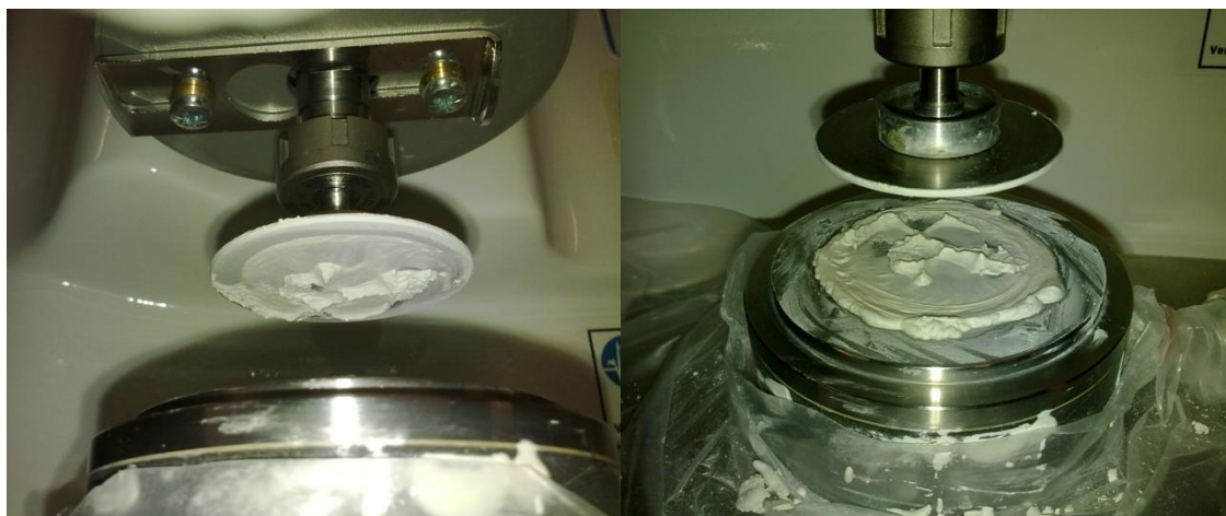
Fig. 4.22. – Aspecto da amostra após o último ensaio (36 min) da pasta acondicionada a 45°C [(a)-parte superior; (b)-parte inferior]
