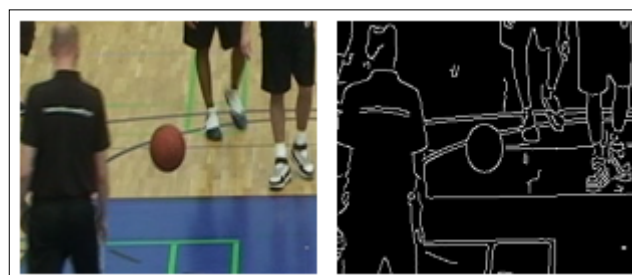
Figura 2.5 - Aplicação do algoritmo de Canny a uma imagem [19].
