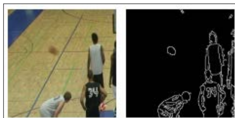
Figura 2.8 - Algoritmo da Canny aplicado à imagem resultante da aplicação da subtração do fundo [19].
