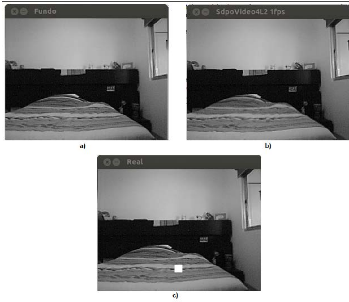
Figura 4.15 - Resultado da aplicação do método para detetar e determinar o centro da bola; a) Fundo; b) Imagem Real; c) Imagem com o método aplicado e um quadrado desenhado à volta da posição calculada para centro da bola.
