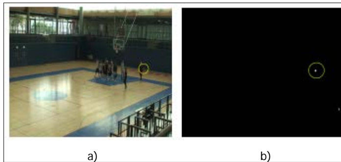
Figura 2.4 - Demonstração do método aplicado para reconhecimento da bola através da cor [19]; a) Imagem original; b) Método aplicado à imagem a).
