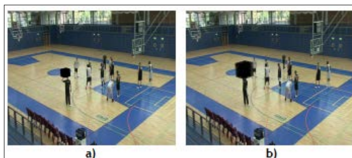
Figura 2.9 - Exemplo da aplicação do algoritmo Trackin-based approach [19]: a) Janela 3D de dimensão 60x60x60 cm; b) Janela 3D de dimensão 120x120x120 cm.
