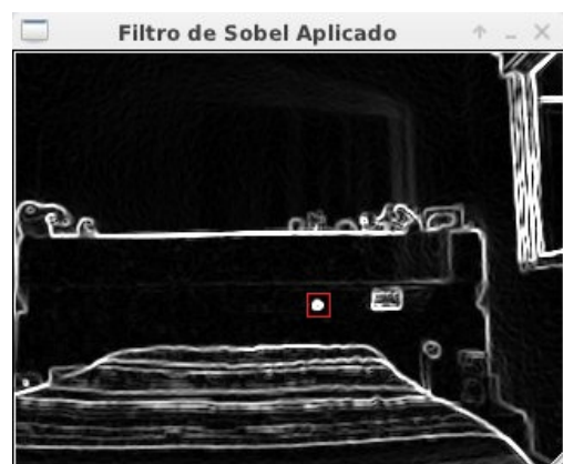
Figura 4.5 - Filtro de Sobel aplicado à imagem da Figura 4.5.
