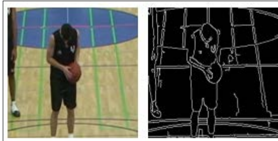
Figura 2.6 - Aplicação do algoritmo de Canny a uma imagem de um jogador com a bola na mão [19].
