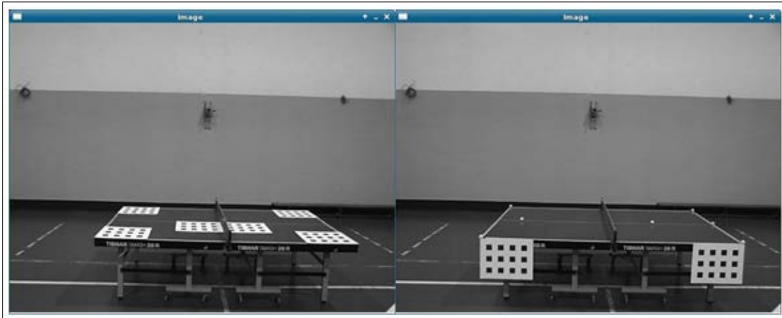
Figura 5.6 - Imagens capturadas com a matriz de pontos em várias posições e com as bolas nas posições conhecidas da mesa.
