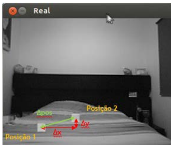
Figura 4.17 - Duas Frames sobrepostas com esquema para o cálculo do \Delta pos .
