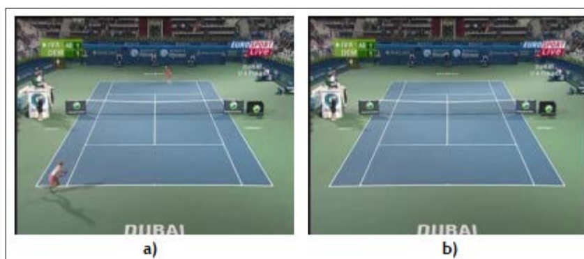
Figura 2.14 - Exemplo da deteção do fundo através de um filtro de mediana [20]; a) Frame original; b) Fundo.
