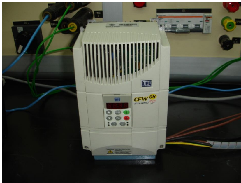
Figura 3.2 - Variador eletrónico de velocidade disponível no LME da FEUP
