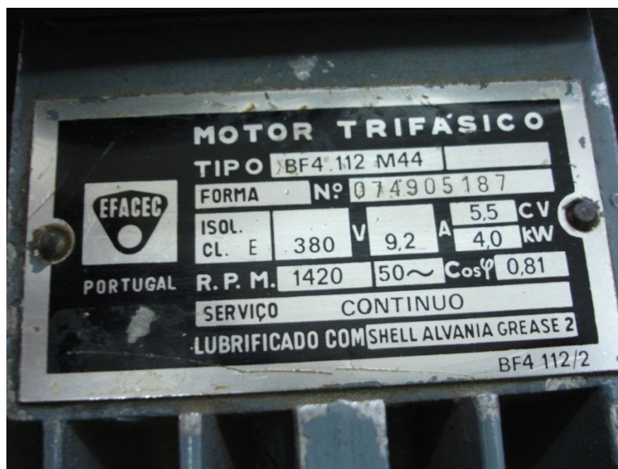
Figura 4.1 - Chapa de características do Motor 1
