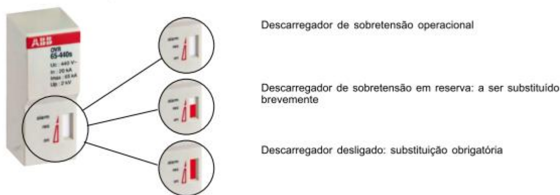
Figura 5.8 - Verificação do estado de funcionamento do DST do fabricante ABB [31]
