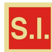
Fig. 5.39 – Sinalização prevista para bocas-de-incêndio
