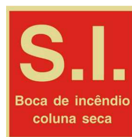
Fig. 5.59 – Sinalização de boca-de-incêndio (coluna seca)
