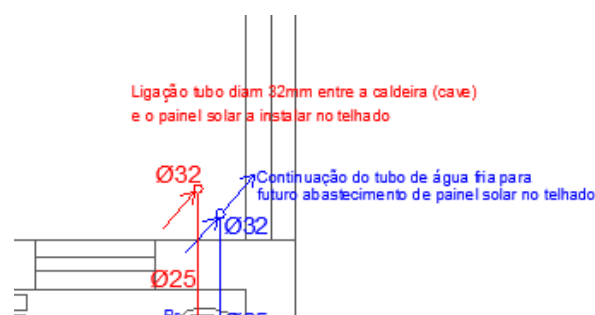
Fig. 63 – Esquema da pré-instalação para painéis solares térmicos
