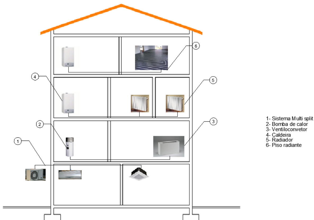
Fig. 16 – Instalações de aquecimento, ventilação e ar condicionado
