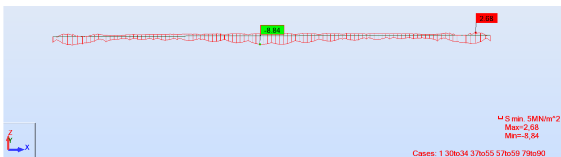
Figura 6.36 – Envoltória das Tensões mínimas na longarina V1
