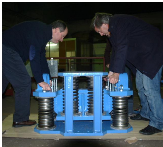
Figura 7.2 – Ensaio de validação dos parâmetros dinâmicos dos TMDs
