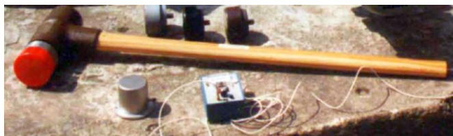
Figura 2.30 – Fotografia de um martelo de impulsos [13]
