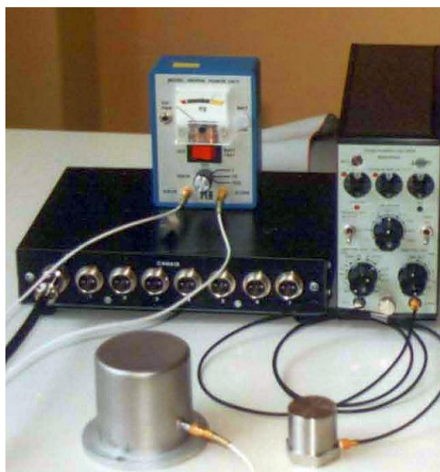
Figura 2.36 – Vários tipos de acelerómetros e amplificadores de sinal [13]
