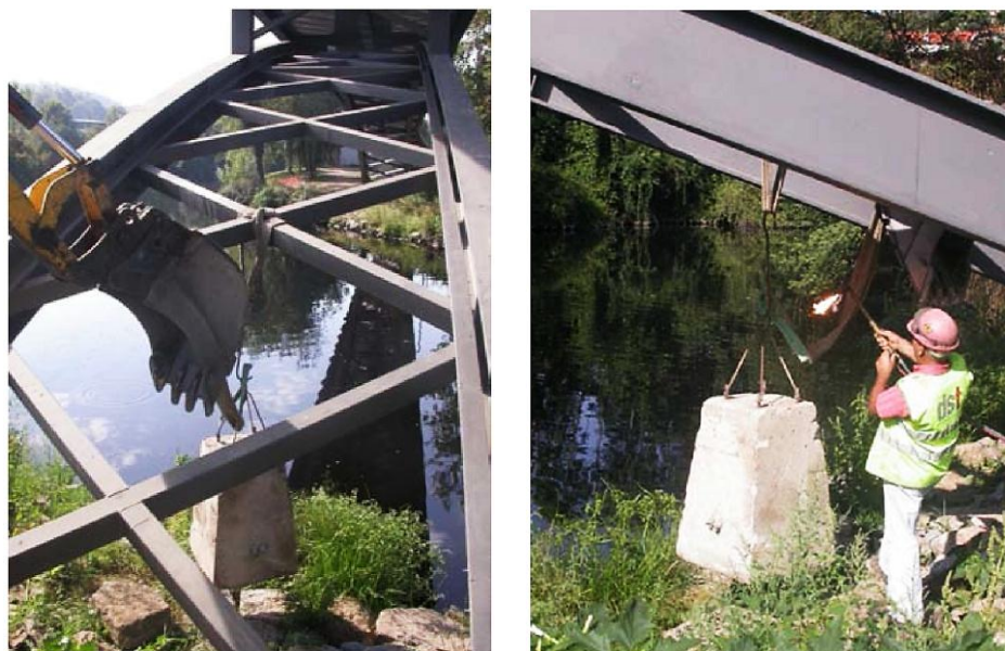
Figura 4.23 – Operações de suspensão e corte do bloco durante os ensaios de vibração livre [25]
