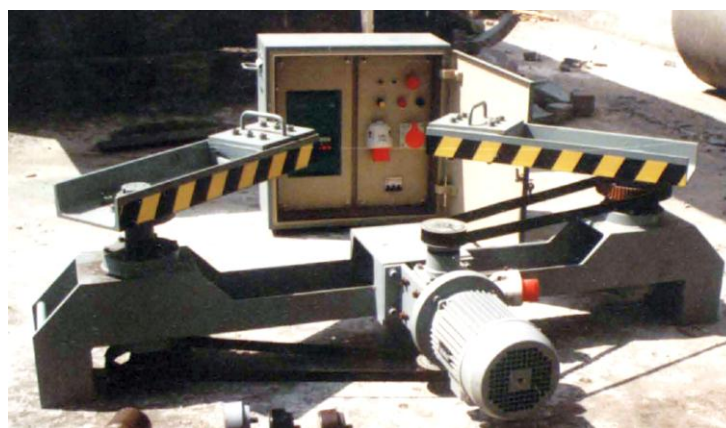
Figura 2.32 – Fotografia de um vibrador de massas excêntricas [13]
