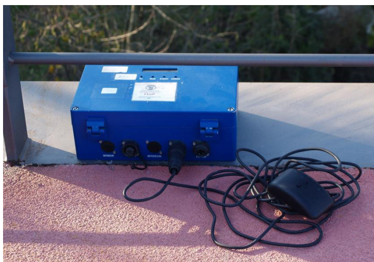
Figura 4.17 – Sismógrafo ligado a GPS durante ensaios na Ponte da Rabada
