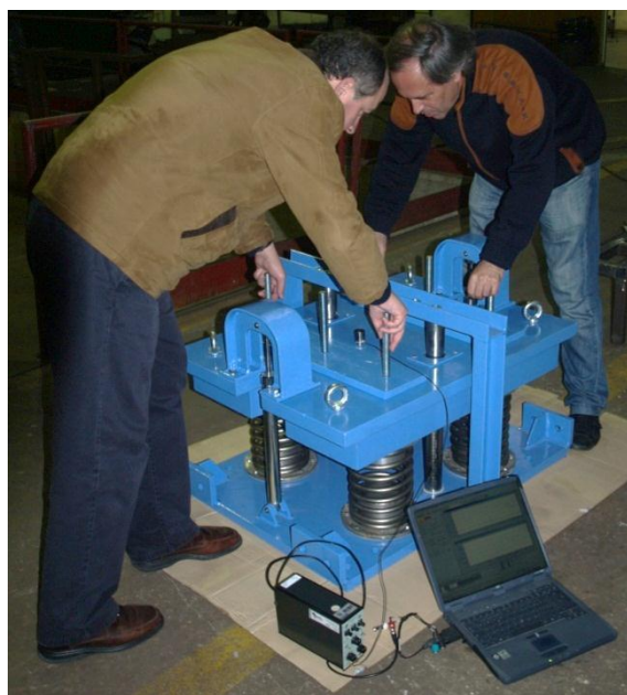
Figura 7.2 – Ensaio de validação dos parâmetros dinâmicos dos TMDs
