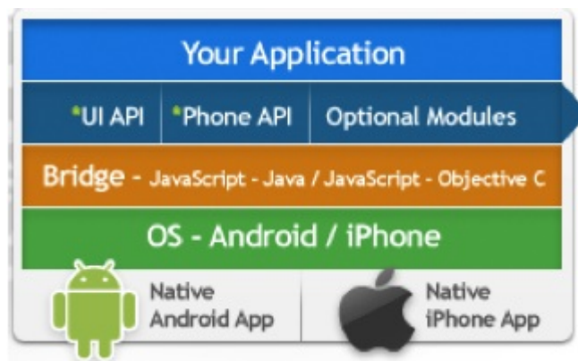
Figura 2.6: Arquitetura do ambiente de desenvolvimento multi-plataforma Titanium
