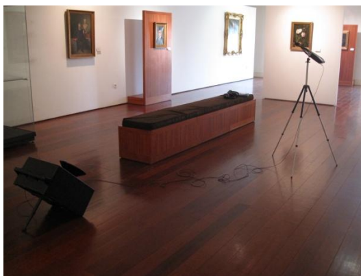
Figs. 5.20 e 5.21 – Fonte sonora Brüel & Kjaer , modelo 4224 (esq.) e equipamento para a realização do ensaio (dir.) [fotos da autora]
