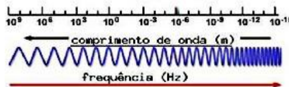
Fig. 2.8 – Relação do comprimento de onda ( \lambda ) com a frequência
