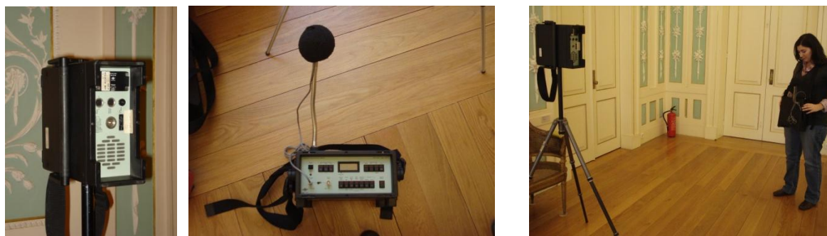
Figs. 5.25, 5.26 e 5.27 – Fonte sonora RASTI Brüel & Kjaer 4225 (esq.), receptor Brüel & Kjaer 4419 (centro) e medição do RASTI (dir.) [fotos da autora]
