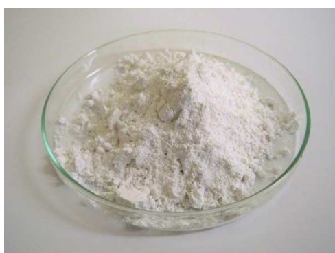
Fig. 18 – Fíler Comercial-Cal Hidratada.
