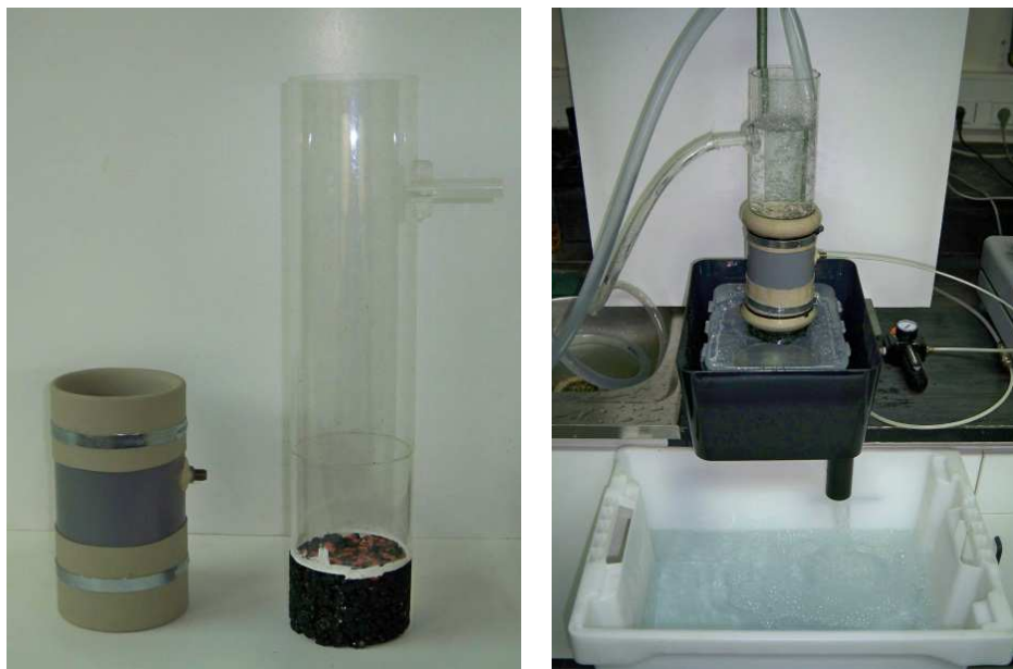
Fig. 51 – Determinação da permeabilidade horizontal.
