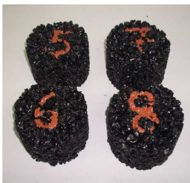
Fig. 34 – Provetes moldados com 10 pancadas por face.
