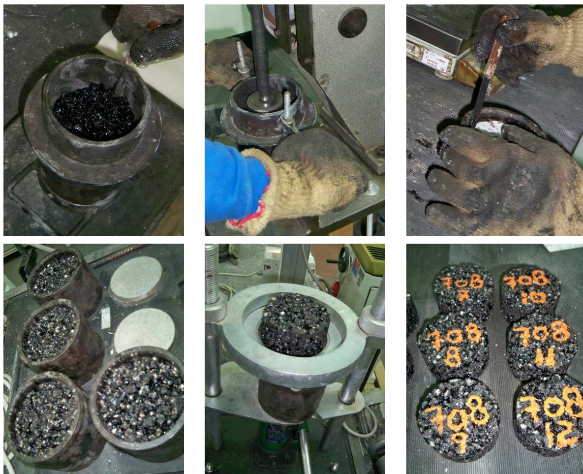
Fig. 31 – Moldagem dos provetes.
