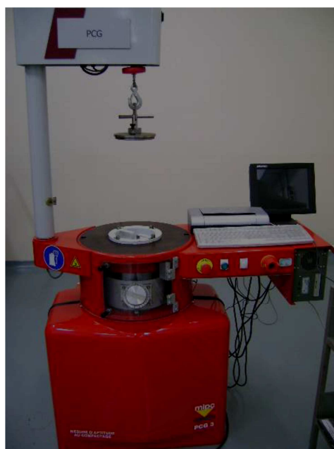
Fig. 5 – Prensa de corte giratória (PCG) (Barra, 2009).
