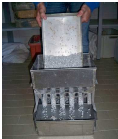
Fig. 28 – Esquartelamento dos agregados.
