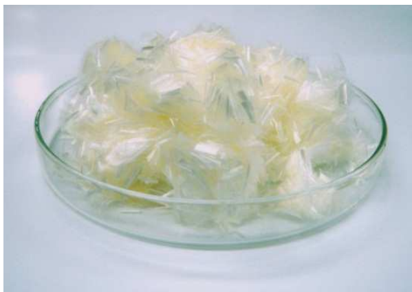
Fig. 23 – Fibras acrílicas Asphalt+.
