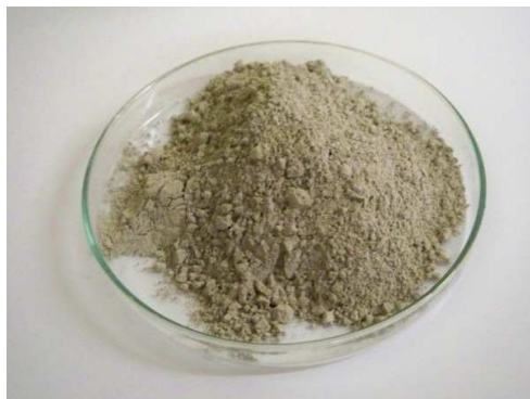
Fig. 17 – Fíler Comercial-Cal Hidráulica.
