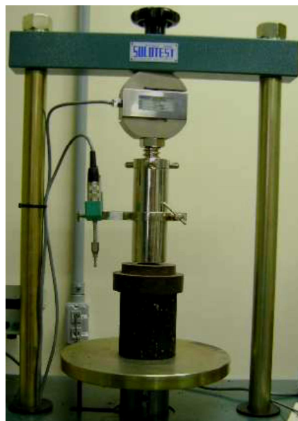
Fig. 7 – Processo de rutura à compressão simples do provete (Barra, 2009).
