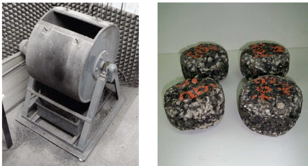
Fig. 8 – Máquina de Los Angeles e provetes ensaiados.
