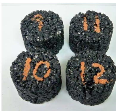
Fig. 35 – Provetes moldados com 50 pancadas por face.
