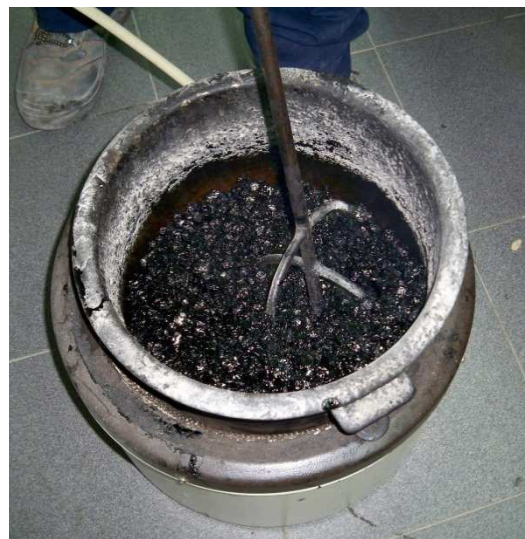
Fig. 30 – Agregados totalmente envolvidos pelo ligante.
