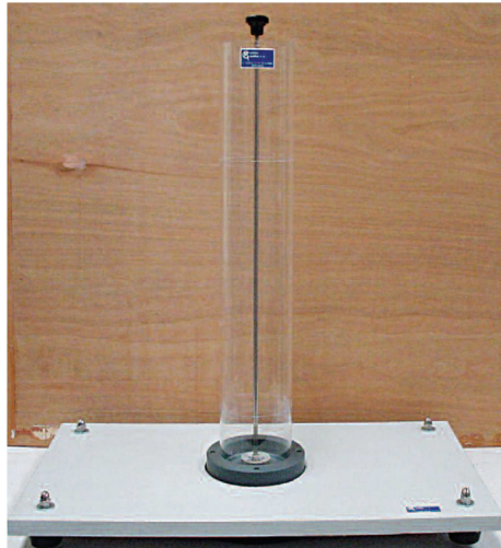
Fig. 60 – Permeômetro “In Situ” da Mecânica Científica, SA.
