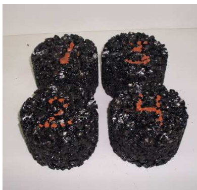
Fig. 33 – Provetes moldados com 20 pancadas por face.
