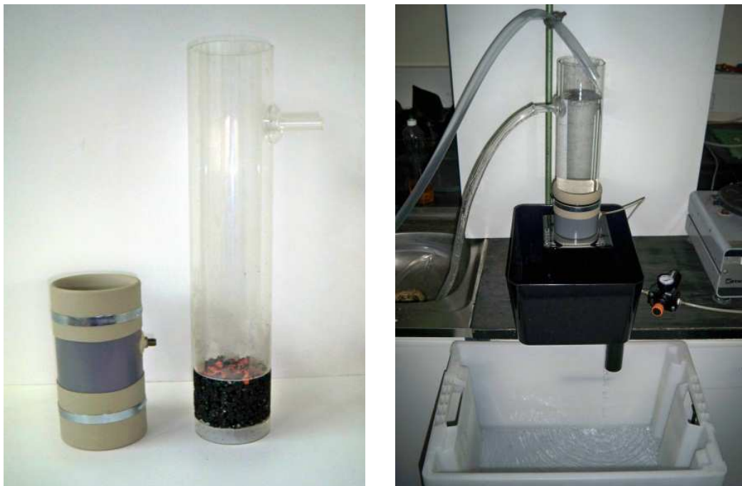
Fig. 48 – Determinação da permeabilidade vertical.
