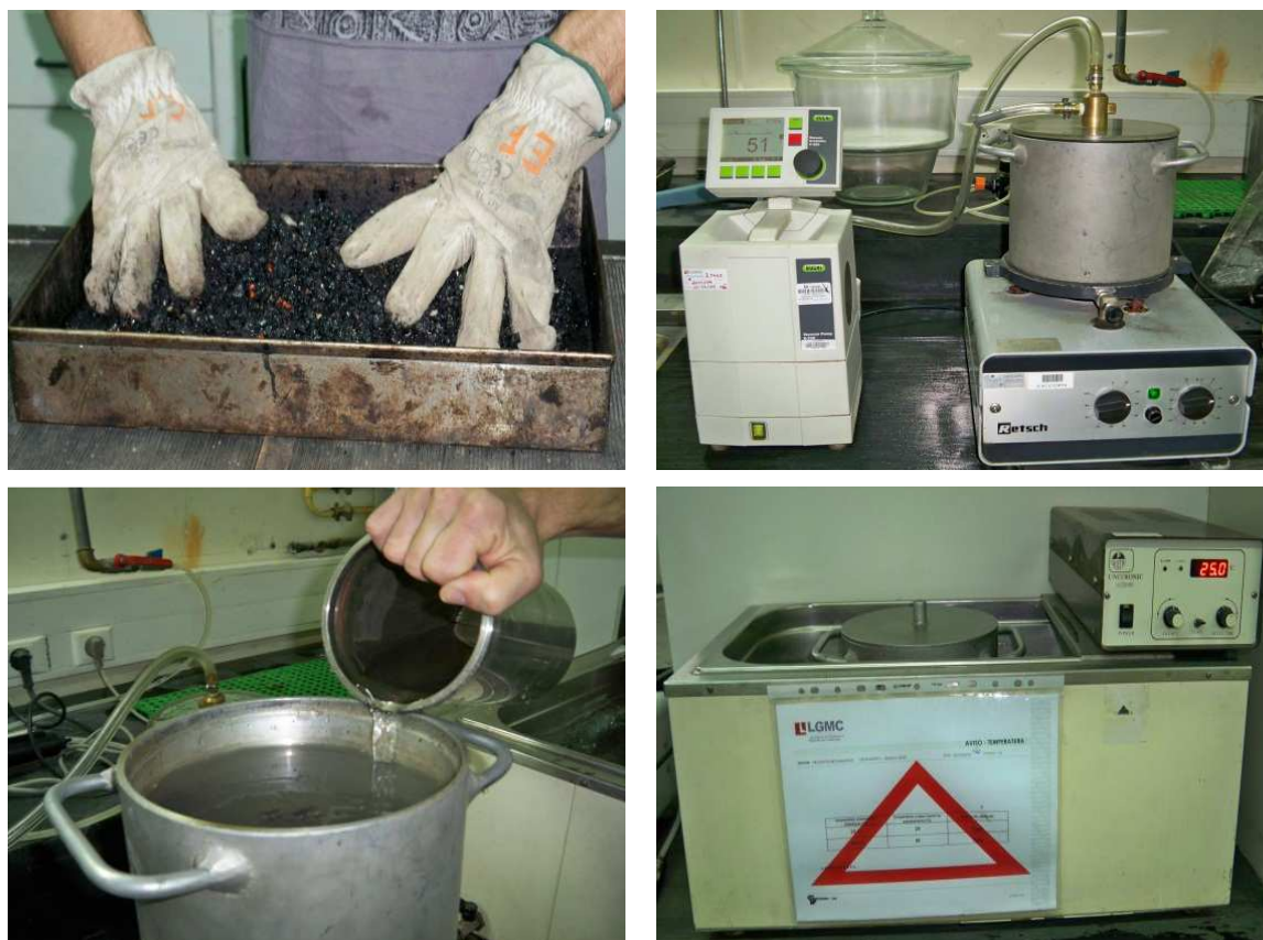
Fig. 40 – Determinação da baridade máxima teórica.
