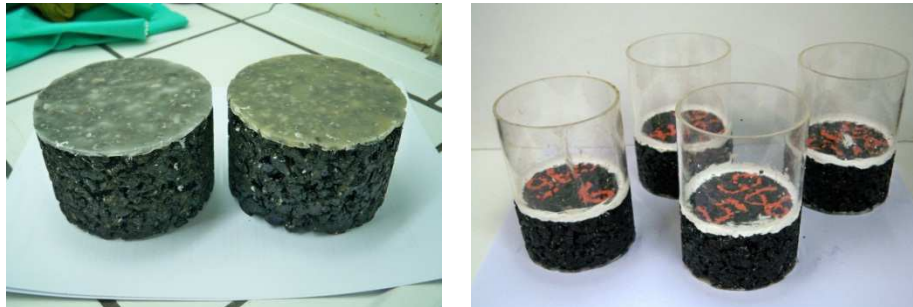
Fig. 50 – Provetes parafinados, e colagem do tubo acrílico.
