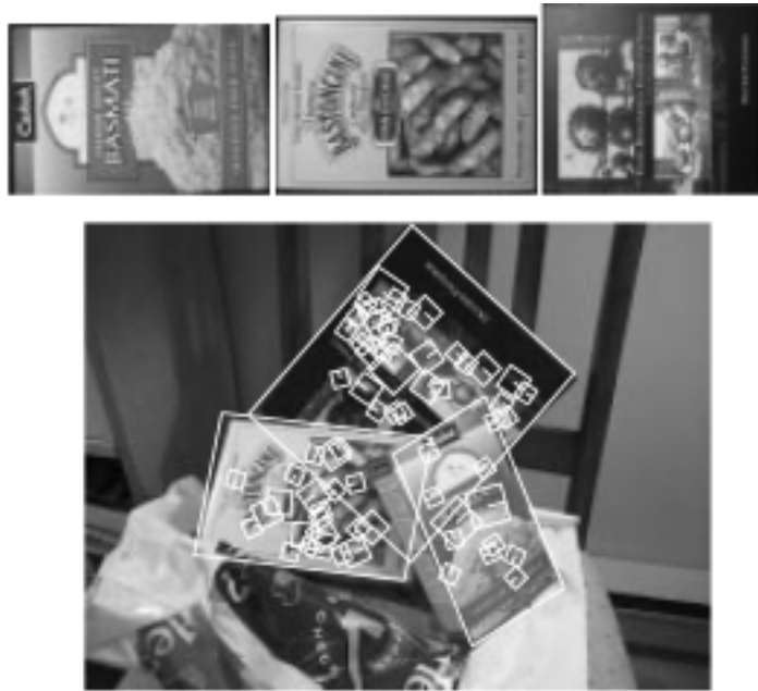
Figura 2.2: Exemplo de Detecção utilizando SIFT [Low99]
