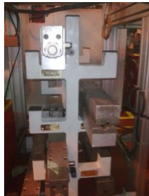
Ilustração 19: Exemplo da identificação de gabarits com chapas metálicas e sensores com etiquetas
