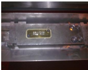
Ilustração 19: Exemplo da identificação de gabarits com chapas metálicas e sensores com etiquetas
