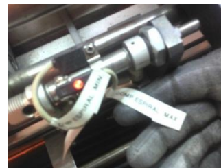
Ilustração 19: Exemplo da identificação de gabarits com chapas metálicas e sensores com etiquetas
