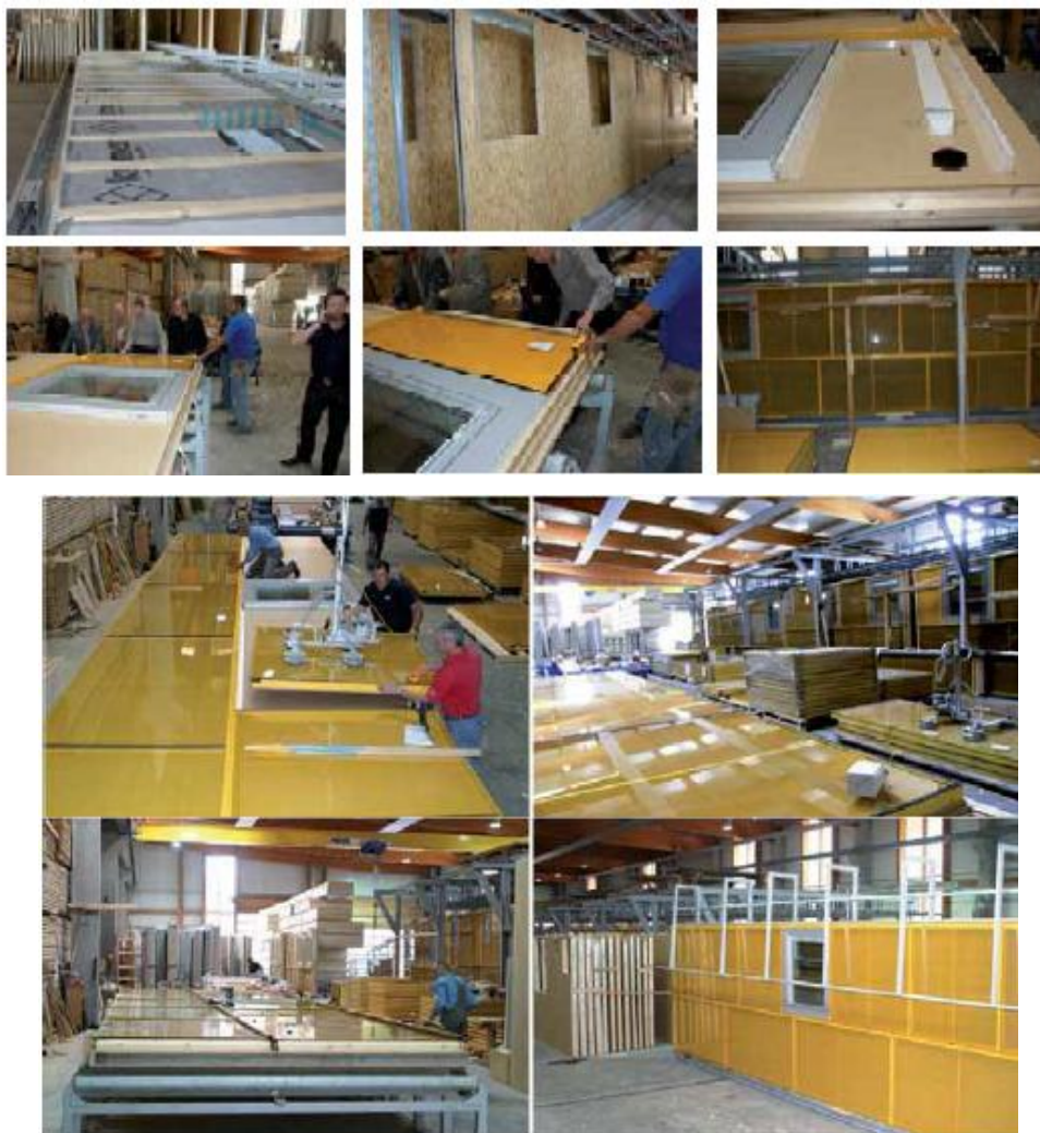
Fig. 2.24 - Montagem do módulo de maiores dimensões em fábrica
