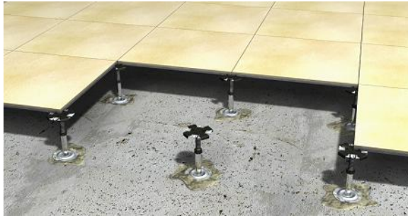
Fig. 2.13 - Exemplo de pré-fabricação leve, piso técnico(CYPE, consultado em 20/01/2012)
