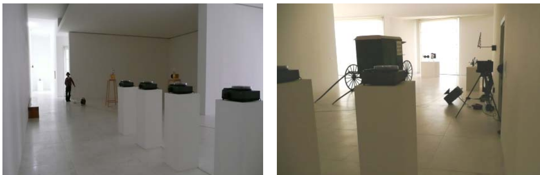
Fig. 5.3 e 5.4 – Medição do tempo de reverberação na sala 12 do Museu de Serralves [Fotos do autor].
