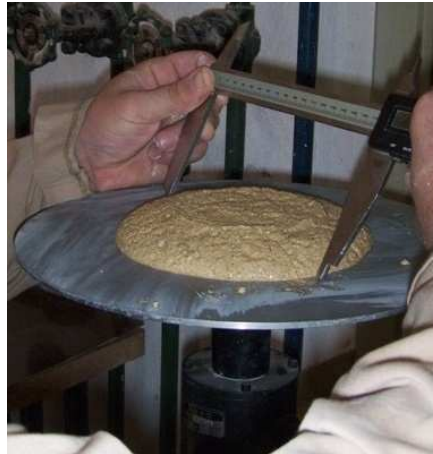
Fig.4.10 – Medição do diâmetro de espalhamento. [32]
