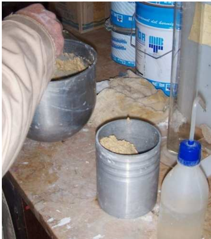
Fig.4.14 – Modo de proceder para o enchimento do recipiente cilíndrico. [32]
