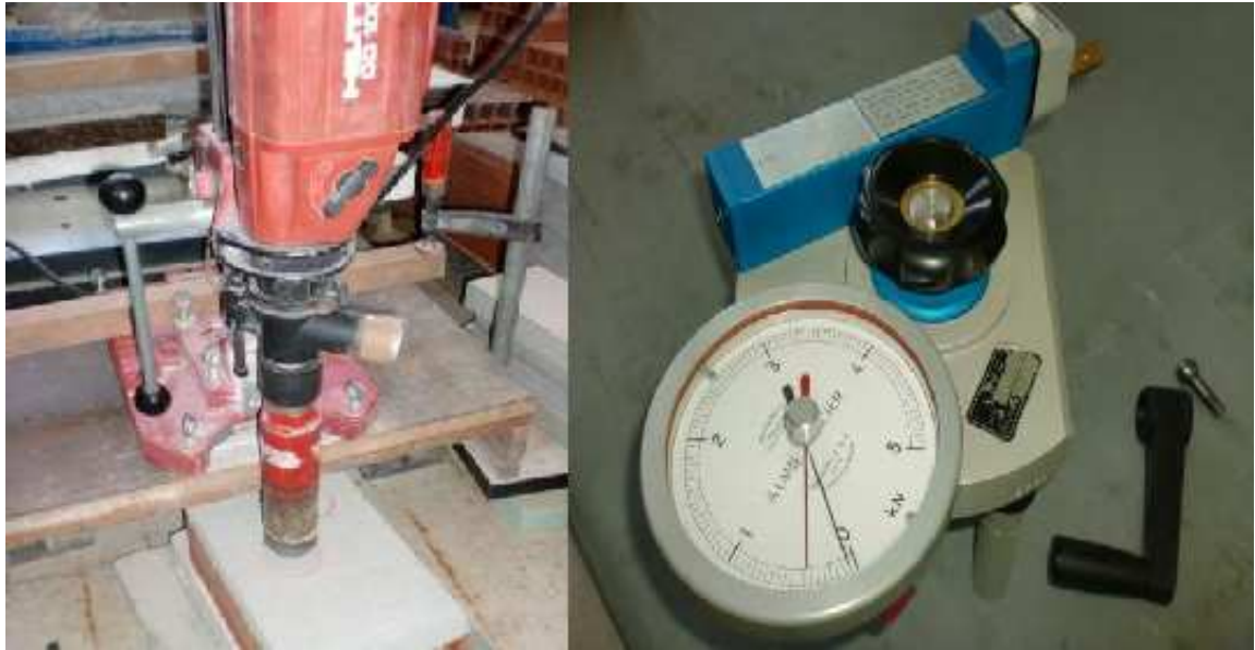
Fig.4.6 – Máquina caroteadora e acessório de arrancamento. [34]
