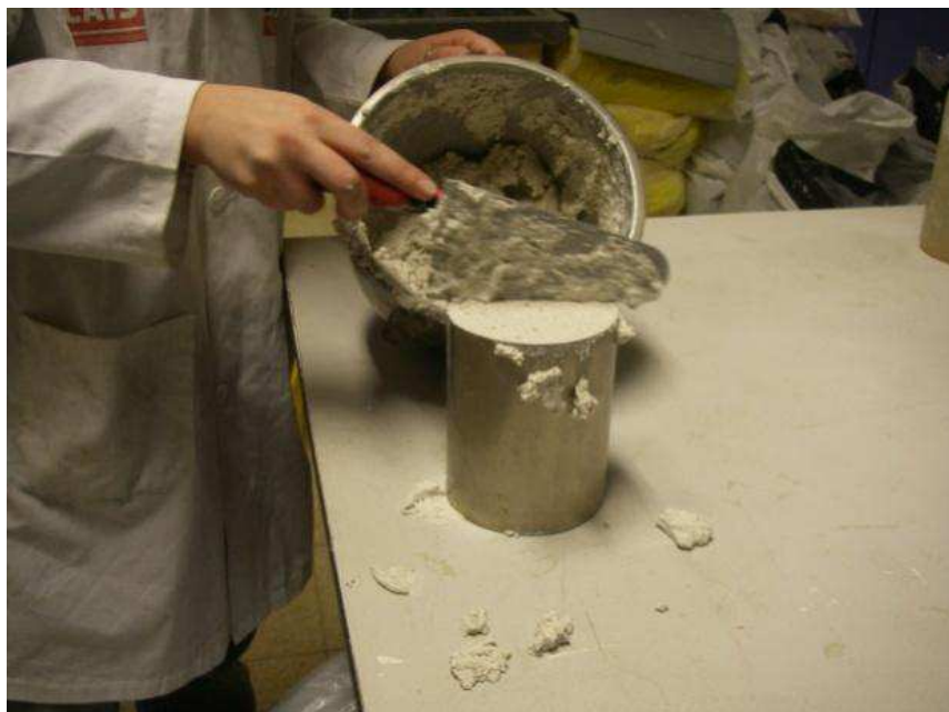
Fig.4.15 – Modo de proceder para retirar o excesso de argamassa. [9]
