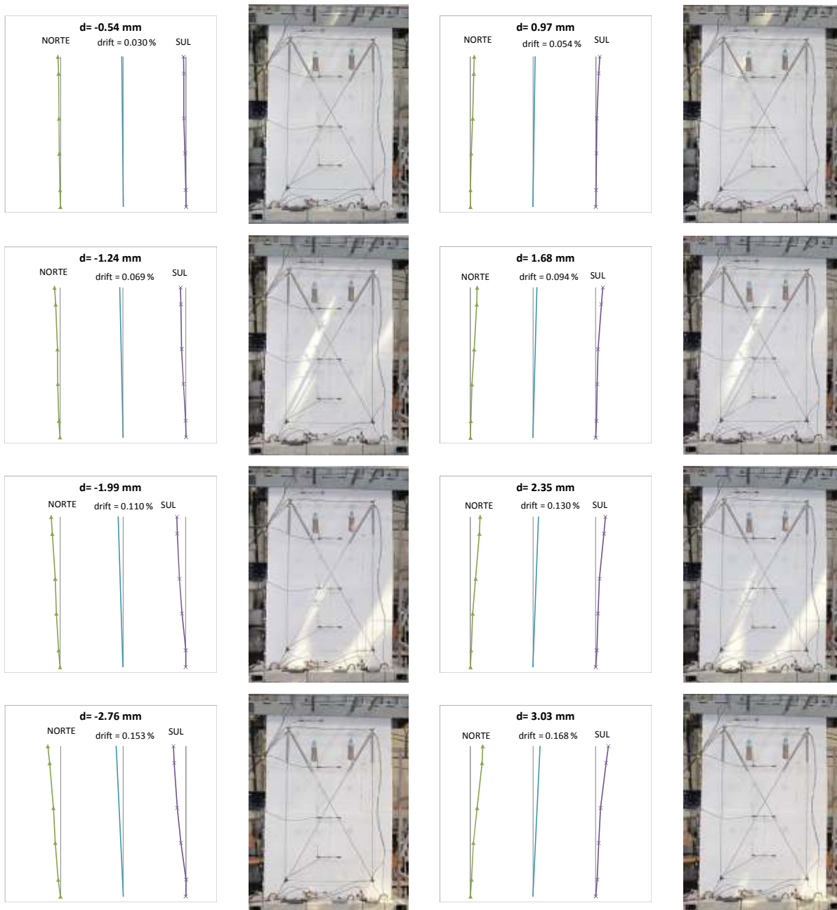
Fig. 4.3 – Deformadas laterais e correspondentes drifts , d em mm (R4 – até -2.76 mm e 3.03 mm).
