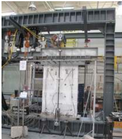
Fig. 3.10 – Estrutura de ensaio e atuador vertical aplicado na maioria dos ensaios.
