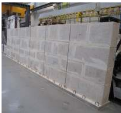
Fig. 3.1 – Parede de alvenaria de pedra regular (R), Almeida (2012).
