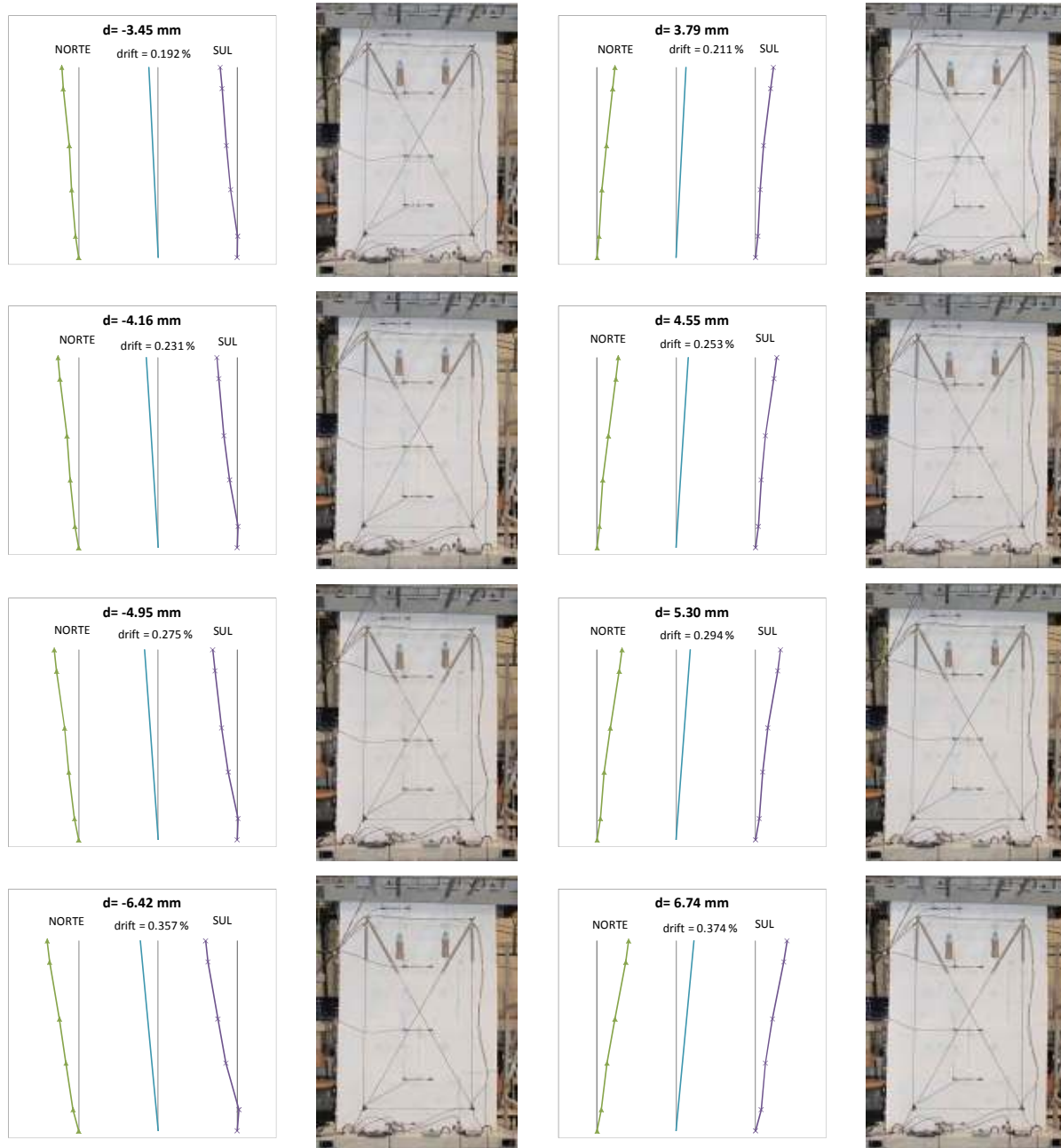
Fig. 4.3 (cont.) – Deformadas laterais e correspondentes drifts , d em mm (R4 – de -3.45 mm até -6.42 mm e 3.79 mm e 6.74 mm).
