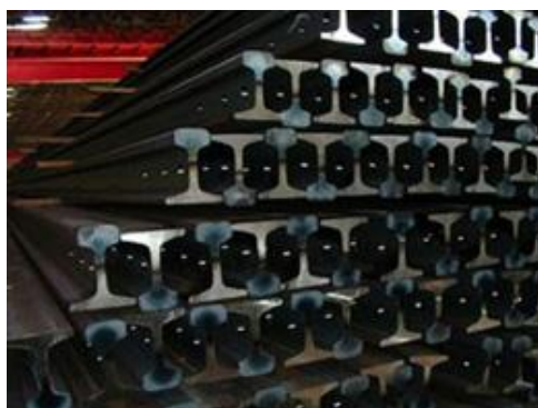
Figura 2.2 – Representação dos perfis UIC60 (Sanzha, 2012).
