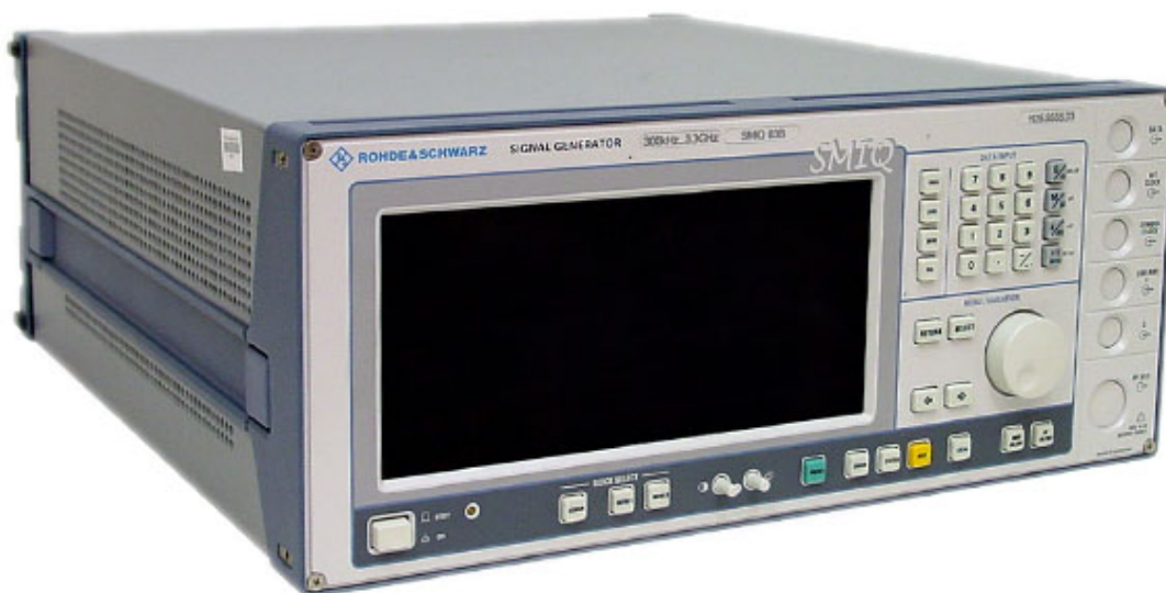
Figura 4.5: Gerador de sinais utilizado: Rohde & Schwarz SMIQ03B Signal Generator
