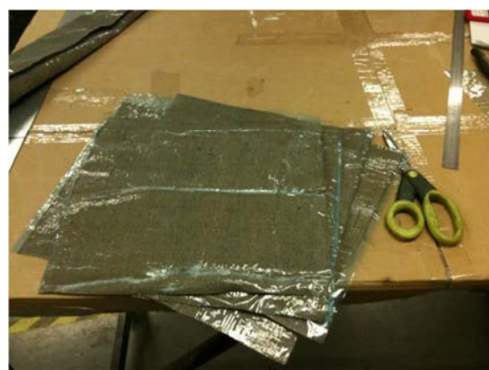
Fig. 6.10 - Marcação do pré-impregnado para o corte das várias camadas (dimensões 300×300 à direita).
