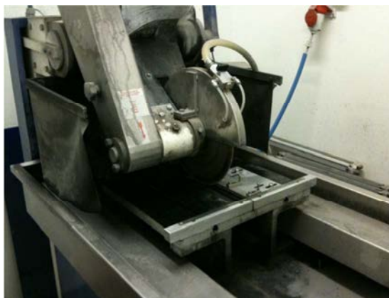
Fig. 6.16 - Máquina de corte com disco diamantado e refrigerada a água.
