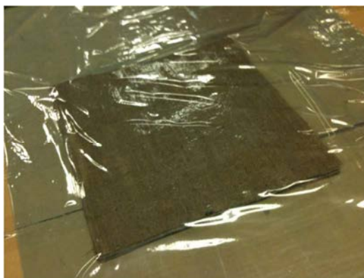
Fig. 6.11 - Empilhamento das várias camadas de pré-impregnado e aplicação de um filme protetor para não haver contato direto com a PPQ ou placa usada para melhorar acabamento de superfície.
