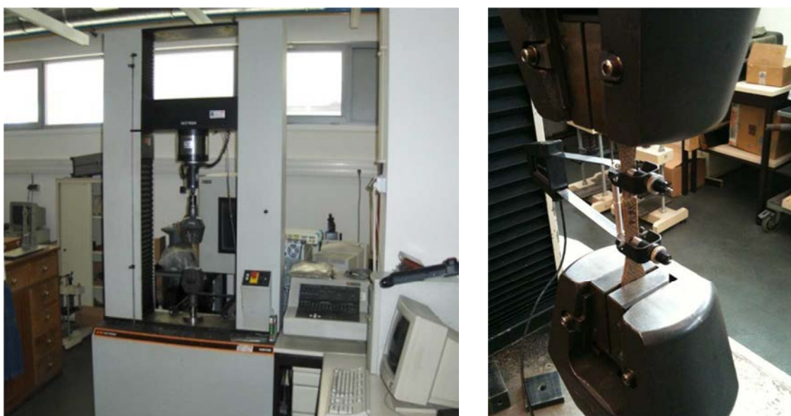
Fig. 6.15 - Na imagem do lado esquerdo apresenta-se o equipamento utilizado para os ensaios de tração. Na imagem do lado direito o aparato com extensômetro montado para ensaio de tração.
