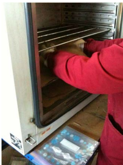
Fig. 6.9 - Colocação das fibras dentro do forno para secagem na imagem do lado esquerdo. Preparação dos moldes para iniciar o processo. Note-se que as fibras estão dentro dos sacos herméticos.
