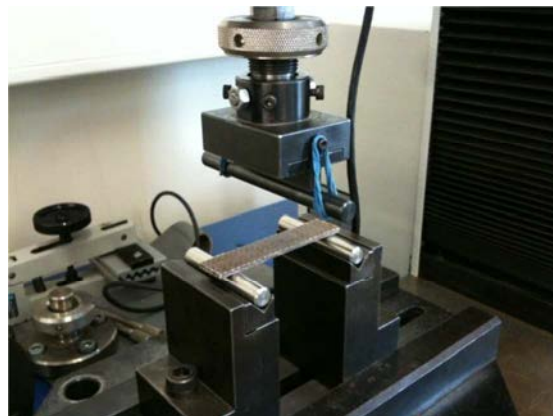
Fig. 6.20 - Na imagem do lado esquerdo apresenta-se o equipamento utilizado para os ensaios de flexão. Na imagem do lado direito o aparato para o ensaio de flexão.
