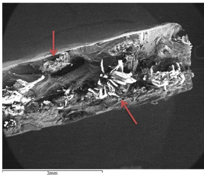
Fig. 6.29 - Visualização de toda a superfície de fratura do provete em análise (3 [mm]).
