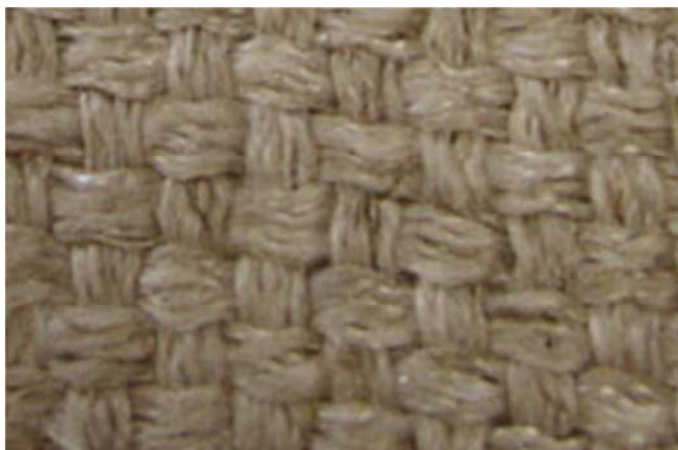
Fig. 6.2 - Configuração do tecido produzido pela Composites Evolution e testado neste trabalho [34].
