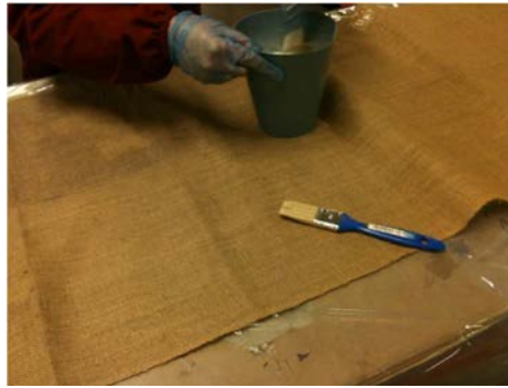
Fig. 6.4 - Impregnação da fibra.
