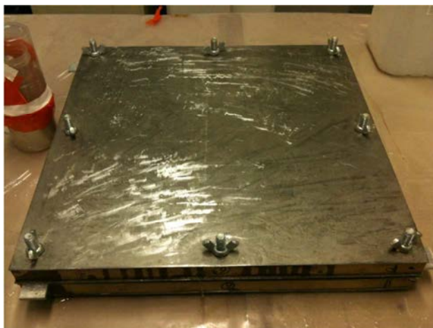
Fig. 6.7 - Molde fechado para cura do compósito sob pressão.
