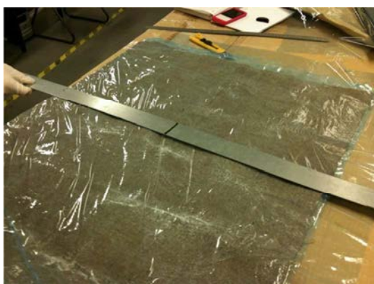
Fig. 6.10 - Marcação do pré-impregnado para o corte das várias camadas (dimensões 300×300 à direita).
