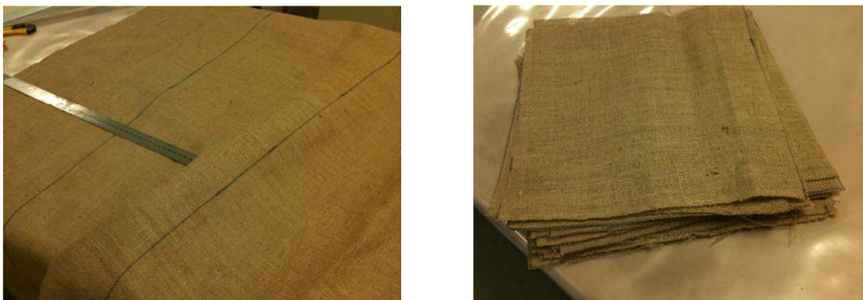
Fig. 6.6 - Marcação da fibra para o corte das várias camadas (dimensões 300 \times 300 à direita).
