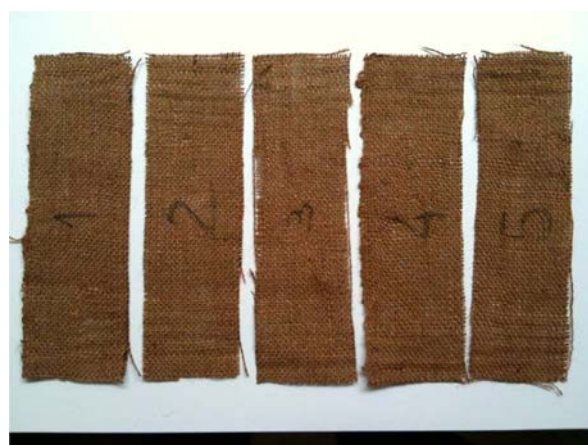
Fig. 6.22 - Provetes de tração da fibra de juta não seca (do lado esquerdo) e da fibra de juta seca a 160 [°C] (do lado direito).
