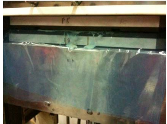
Fig. 6.12 – Placa de metal posta na face superior e inferior do compósito para se conseguir um melhor acabamento superficial na imagem do lado esquerdo. Moldação na PPQ na imagem do lado direito.
