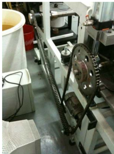
Fig. 5.4 - Transmissão feita a dois rolos com um moto-redutor e ausência de esticador para uma das transmissões.
