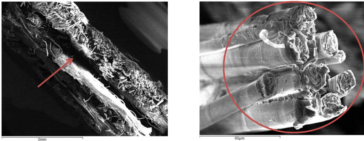
Fig. 6.33 - Imagem do lado esquerdo apresenta uma delaminação (3 [mm]) e a imagem do lado direito um conjunto de fibras de linho (60 [μm]).
