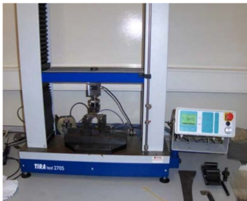
Fig. 6.20 - Na imagem do lado esquerdo apresenta-se o equipamento utilizado para os ensaios de flexão. Na imagem do lado direito o aparato para o ensaio de flexão.
