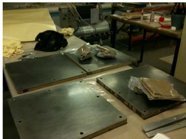
Fig. 6.9 - Colocação das fibras dentro do forno para secagem na imagem do lado esquerdo. Preparação dos moldes para iniciar o processo. Note-se que as fibras estão dentro dos sacos herméticos.
