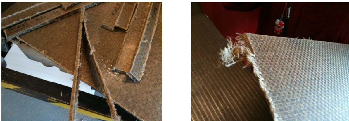
Fig. 6.18 - Na imagem do lado esquerdo ocorreu delaminação durante o corte. Na imagem do lado direito ocorreu desfibramento durante o corte.
