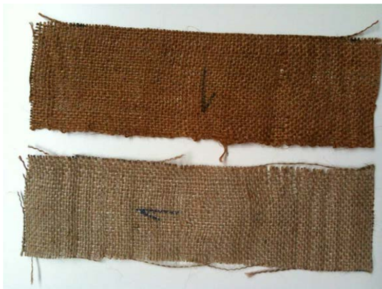
Fig. 6.23 - Comparação da coloração da fibra de juta não seca (fibra de baixo) e da fibra de juta seca a 160 [°C] (fibra de cima).
