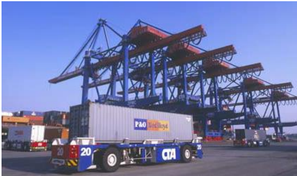
Figura 30. Exemplo de um AGV. Fonte: (Steenken, Vob, & Stahlbock, 2004)
