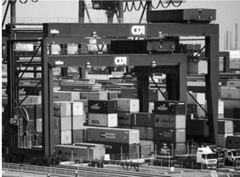
Figura 33. Exemplo de rail-mounted gantry crane . Fonte: (Steenken, Vob, & Stahlbock, 2004)
