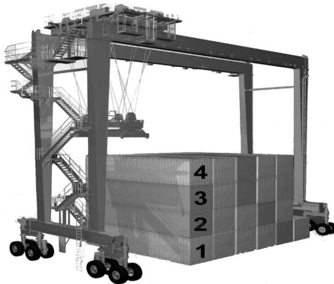
Figura 34. Exemplo de rubber tired gantry crane . Fonte: (Ting, Wang, Kao, & Pitty, 2010)
