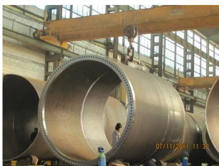
**Figura 6 - Flange montada num tramo**
