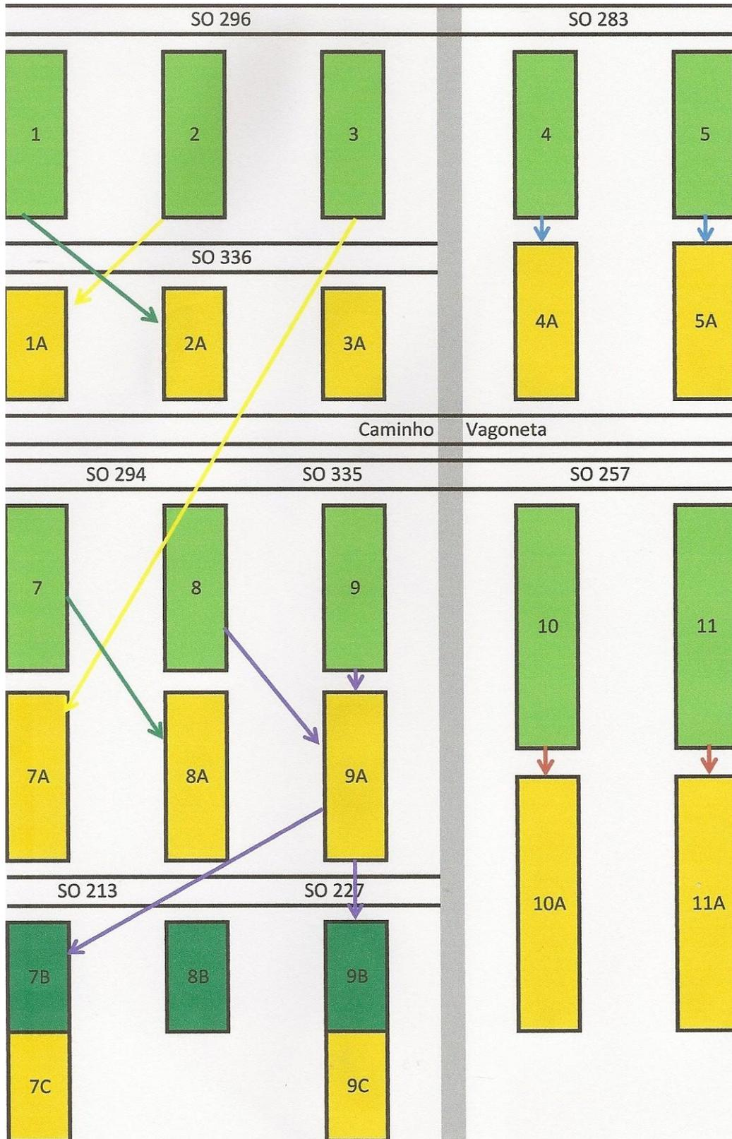
**Figura 9-**Layout esquemático dos postos de trabalho e movimentações dos tramos
