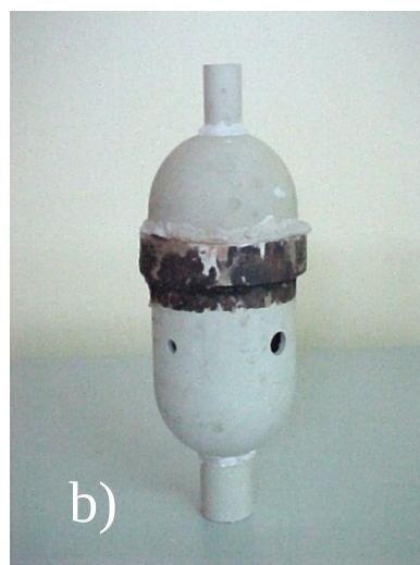
Figura 3. 2 – Fornalha de 1,2 L de capacidade (Pilão, 2003) a) aspeto exterior, b) reator cerâmico
