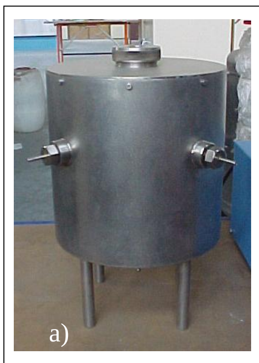
Figura 3. 2 – Fornalha de 1,2 L de capacidade (Pilão, 2003) a) aspeto exterior, b) reator cerâmico
