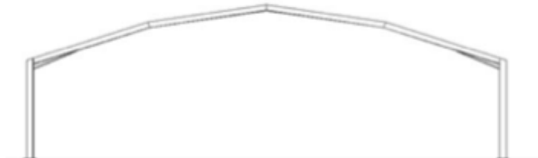
Figura 2.6 - pórtico com cobertura poligonal
