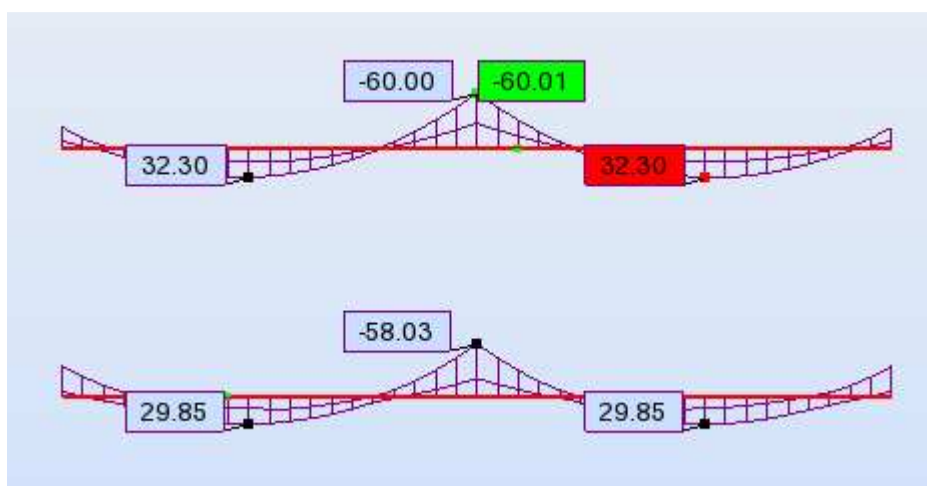
Figura 36 - Envoltura de momentos nas vigas da estrutura "B.A. 2"
