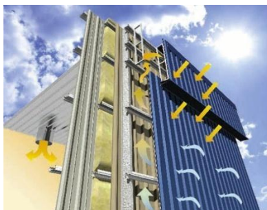
Figura 3.13 - Princípio de funcionamento de um sistema SolarWall . [65]
