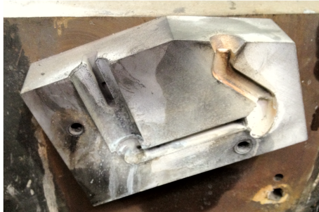
Figura 15 - Coquilha utilizada no vazamento das várias ligas de alumínio
