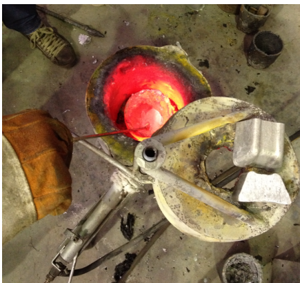
Figura 16 - Fusão do alumínio em forno de cadinho aquecido a gás
