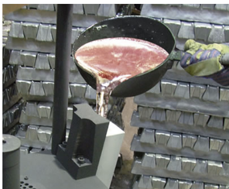
Figura 5 - Enchimento manual de coquilha [27]
