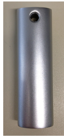
Figura 25 - Liga de alumínio Ag4Z após anodização
