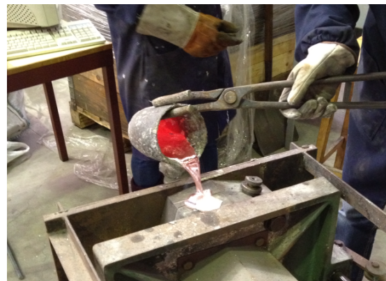
Figura 17 - Vazamento manual do alumínio a 750°C para a coquilha
