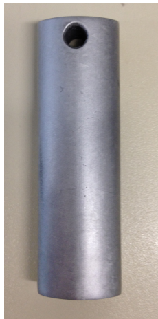
Figura 24 - Liga de alumínio AlSi_7 após anodização
