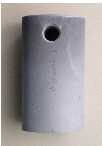
Figura 28 - Amostra revestida por PVD após anodização e tratamento químico de limpeza da camada anodizada
