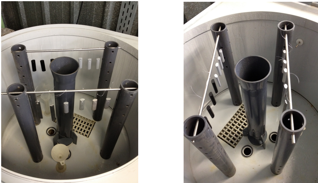
Figura 29 - Posicionamento das amostras na câmara de nevoeiro salino de dois ângulos diferentes
