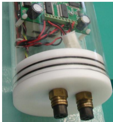
Figura 4.11 - End Caps com conectores Subconn para alimentação dos motores
