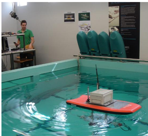
Figura 5.8 - ASV controlado remotamente na piscina de testes
