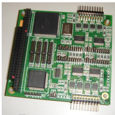
Figura 3.4 - Placa EMERAL-4M-XT com 4 portas série configuráveis
