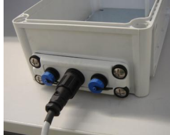
Figura 4.5 - Painel lateral com conectores para cabo e antenas
