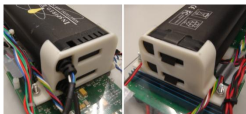
Figura 4.12 - Peças para suporte das baterias
