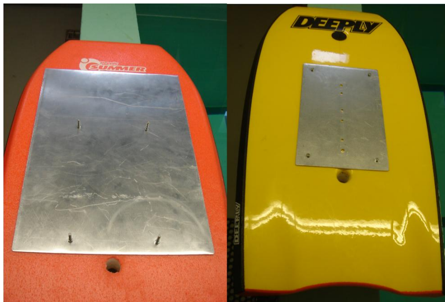
Figura 4.4 - Adaptações à prancha: furação da prancha e fixação das placas de alumínio
