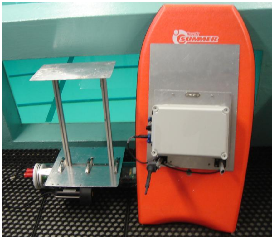
Figura 4.2 - Desmantelamento mecânico do ASV em dois módulos
