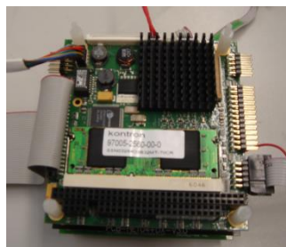
Figura 3.3 - Placa CPU Kontron MOPSlcdVE
