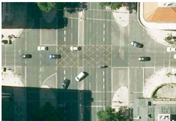
Figura 136 – BOX marca 17b numa interseção regulada por sinais luminosos – Lisboa (Google Earth 2012)
