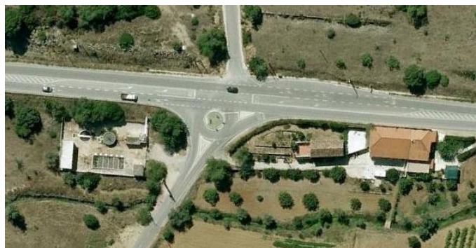
Figura 19 – Interseção de 4 ramos em “X” com canalização de tráfego demarcada na via principal, com canalização de tráfego materializada e demarcada na via secundária (ilha separadora pouco convencional) – EN125 – Algarve (Google Earth 2012)
