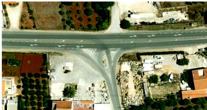
Figura 12 – Interseção prioritária de 4 ramos em “Cruz” com canalização de tráfego demarcada e ilha central materializada na via secundária – EN125 – Algarve (Google Earth 2012)
