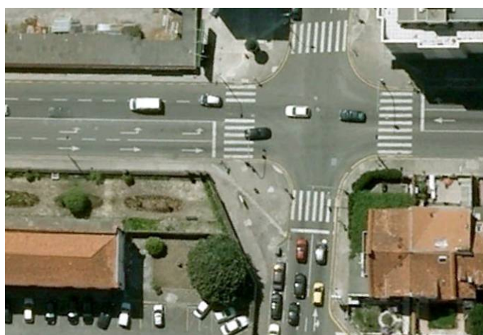
Figura 113 – Marcas em interseção urbana com duas vias por sentido – Porto (Google Earth 2012)
