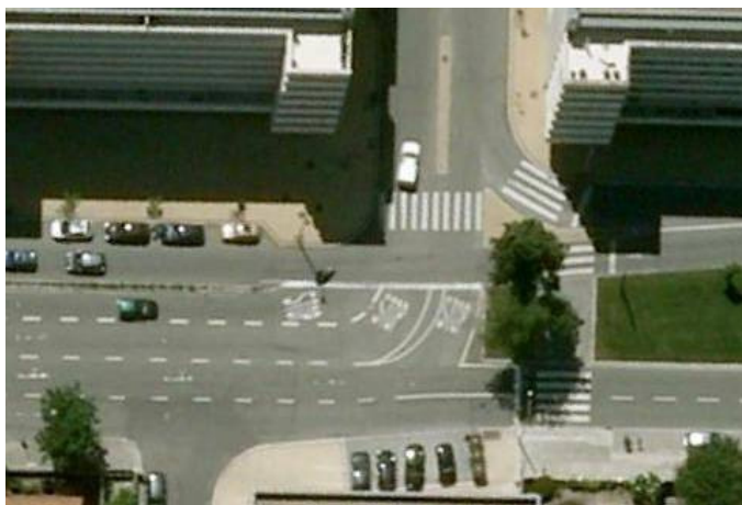
Figura 118 – Linha de paragem incorretamente com três inscrições “STOP” – Porto (Google Earth 2012)
