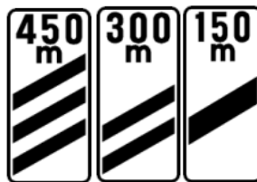
Figura 84 – Sinais O4a O4b e O4c de aproximação de saída em IC ou outra estrada
