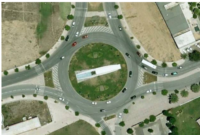
Figura 126 – Situação correta com travessias de peões afastadas do anel de circulação e perpendiculares às vias – Faro (Google Earth 2012)
