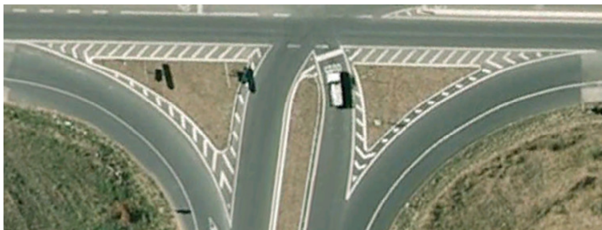
Figura 143 – Ilhéus separadores com envolvimento pelas raias oblíquas (M17a) A linha de quebra está mal desenvolvida na raia do ilhéu da esquerda e bem no ilhéu da direita – EN125 Algarve (Google Earth 2012)
