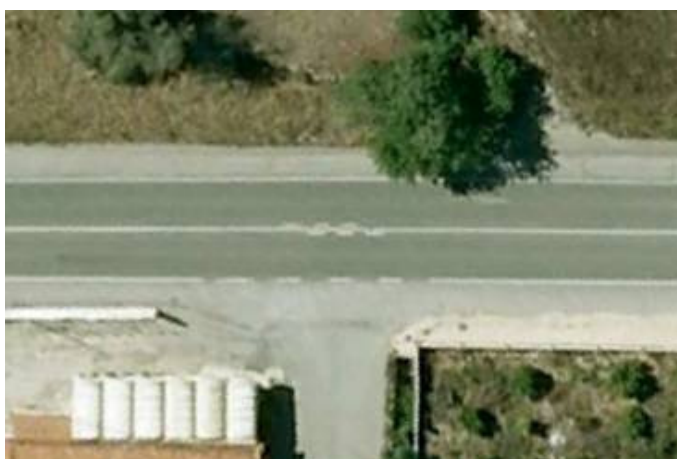
Figura 115 – Linhas descontínuas adjacentes à linha contínua – Algarve (Google Earth 2012)
