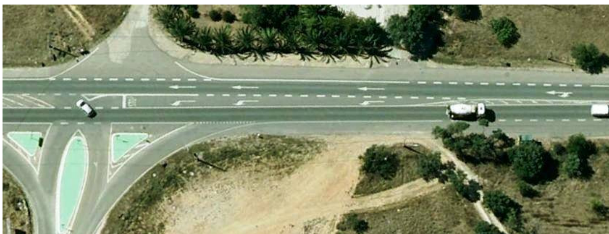
Figura 128 – Setas de seleção em interseção de nível – EN125 – Algarve (Google Earth 2012)
