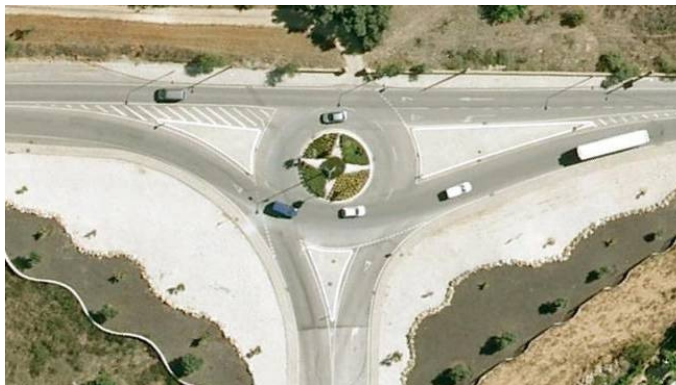
Figura 20 – Rotunda com trajetórias diretas a evitar – Algarve (Google Earth 2012)
