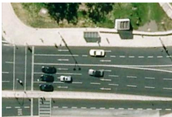
Figura 130 – Cinco vias no mesmo sentido de acesso a uma interseção, todas com setas de seleção M15 simples em frente – Lisboa (Google Earth 2012)
