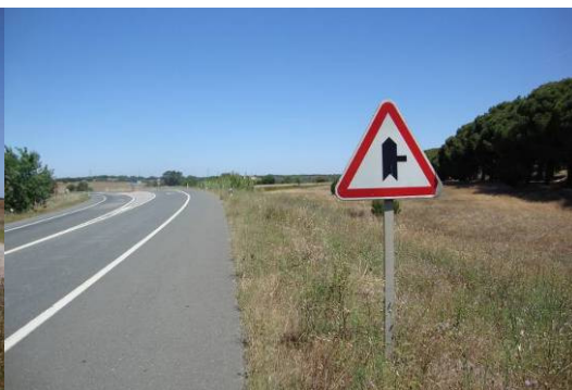
Figura 162 – Interseção prioritária – Sinal B9b – Isolado do lado direito
