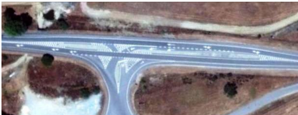
Figura 142 – Transição de larguras entre secção corrente e secção na interseção ao longo da zona raiada – IC1 (Google Earth 2012)
