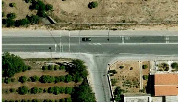
Figura 10 – Interseção prioritária de 3 ramos em “T” sem canalização – EN125 – Algarve (Google Earth 2012)
