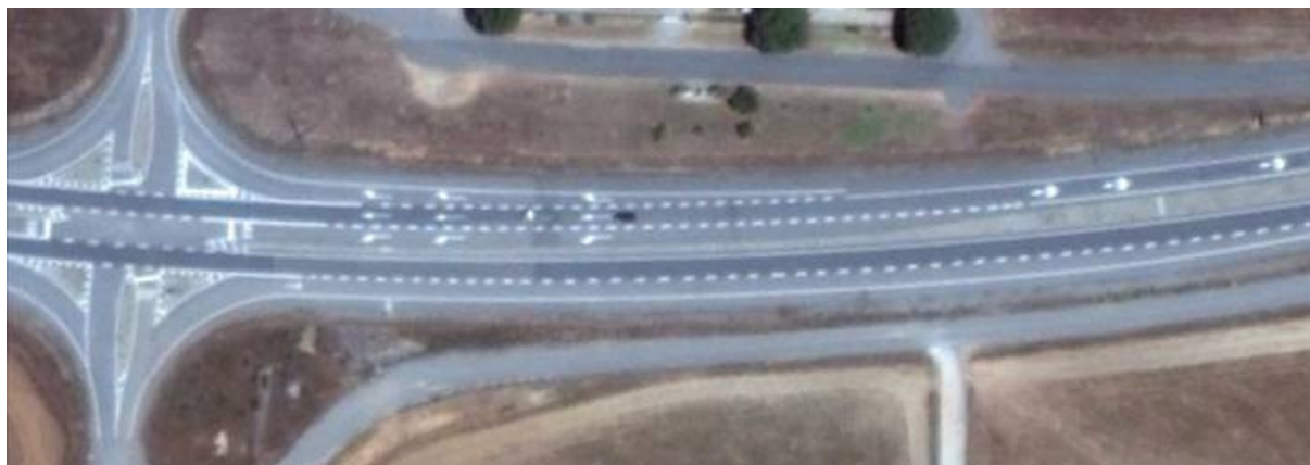
Figura 129 – Dois grupos de setas de seleção em interseção canalizada IP2 – Alentejo (Google Earth 2012)
