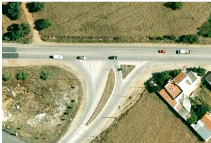
Figura 141 – Raias oblíquas utilizadas para definir ilhéu direcional – EN125 Algarve (Google Earth 2012)
