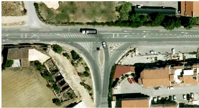
Figura 14 – Interseção prioritária “desalinhada” com canalização de tráfego demarcada na via principal e materializada e demarcada na via secundária – EN125 – Algarve (Google Earth 2012)
