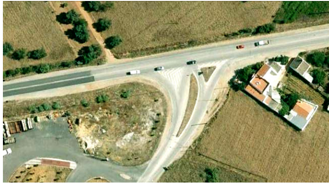
Figura 13 – Interseção prioritária de 3 ramos em “Y” com canalização de tráfego materializada e demarcada na via secundária – EN125 – Algarve (Google Earth 2012)
