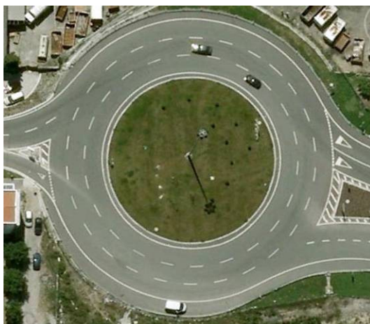
Figura 116 – Marcas longitudinais em rotunda – Porto (Google Earth 2012)
