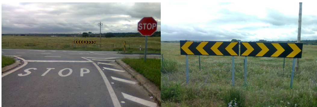
Figura 94 – Baia O6b colocada lado a lado na via principal de uma interseção em “T” – IC1
