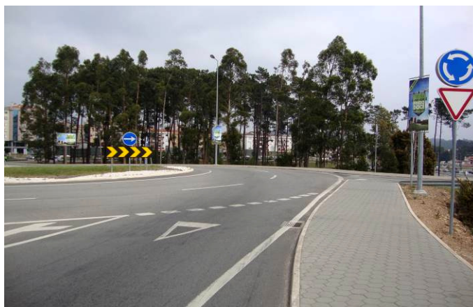
Figura 95 – Baia direcional múltipla (O6b) e sinal D1a em via única – Feira
