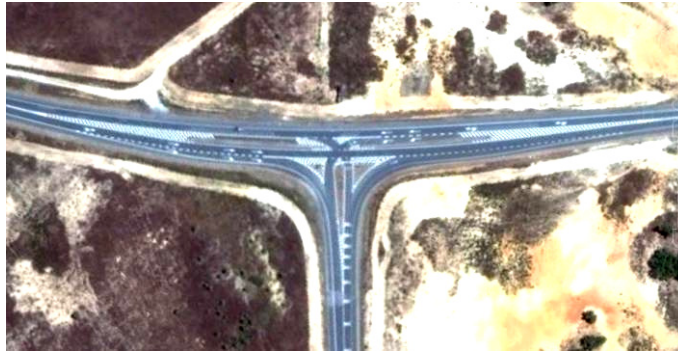
Figura 16 – Interseção prioritária de 3 ramos em “T” com canalização de tráfego materializada na via principal e na via secundária, com vias de aceleração e desaceleração – IC1 – Grândola (Google Earth 2012)
