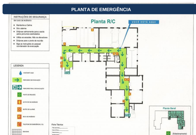
Figura 2.4 – Exemplo de planta de emergência, [10].
